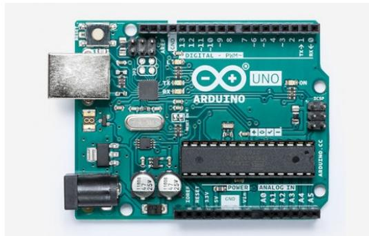
Slika 4. - Arduino uno mikrokontroler
