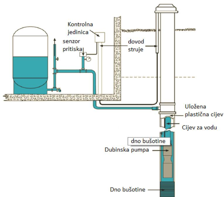
Slika 2. - Shema jednostavnog sustava vodoopskrbe iz bušotine
