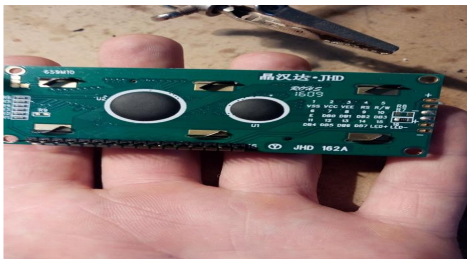
Slika 27: LCD zaslon – stražnja strana [Izvor: Izradio autor]
