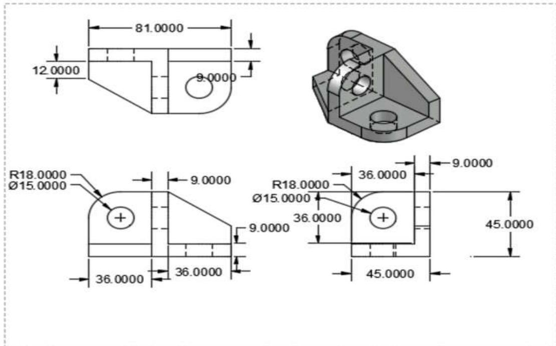
Slika 22. Solidworks 2D crtež generiran iz 3D modela
