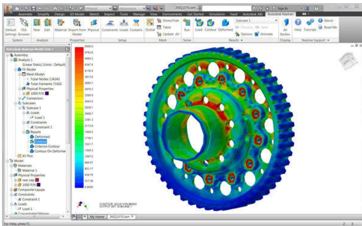
Slika 13. Autodesk Inventor 2019; analiza naprezanja zupčanika
