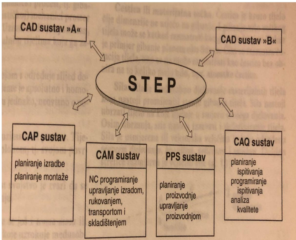
**Slika 30:** Shema razmjene informacija između CAD/CAM/CAE programske sustava pomoću STEP standarda [15]
