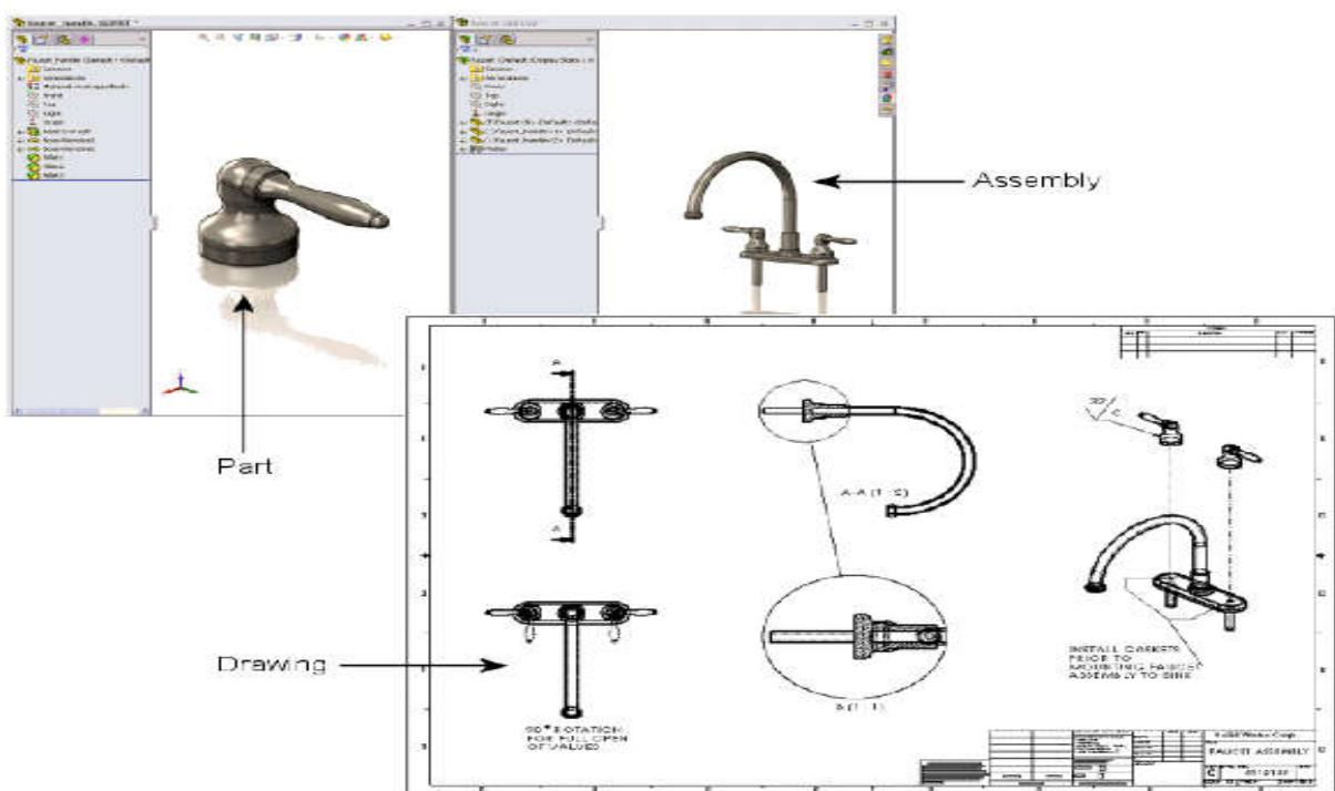
Slika 23. Prikaz promjena koje provode kroz Solidworks
