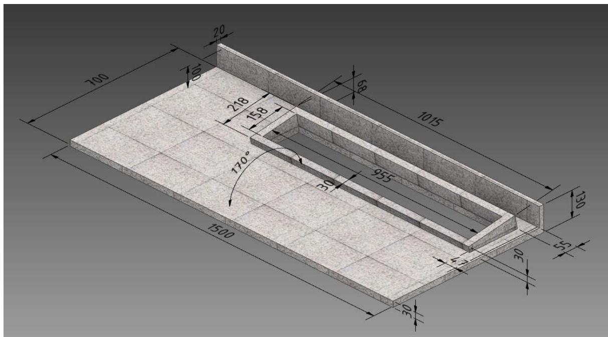
**Slika 14.** Parametarski model granitne ploče – dimenzijska ograničenja
