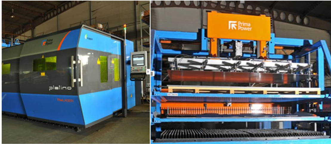
Slika 16. Obradni centar “Platino Fiber” s automatskim punjačem limova 33
