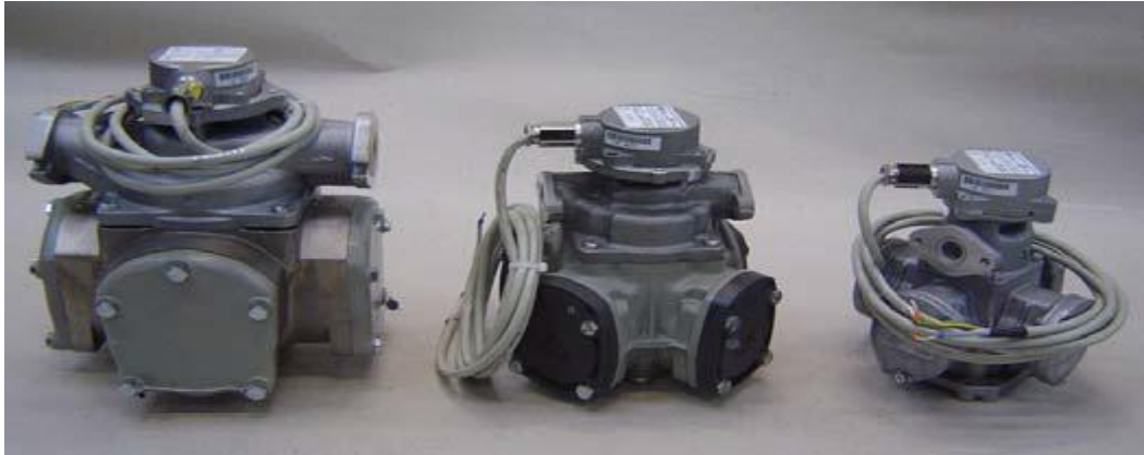
Slika 6: Volumometri KM250; KMO; KMI. Izvor: 14
