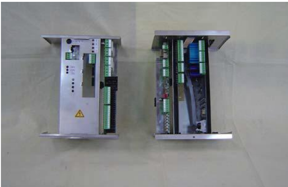
Slika 11: Elektroničko brojilo T20, Izvor: 25
