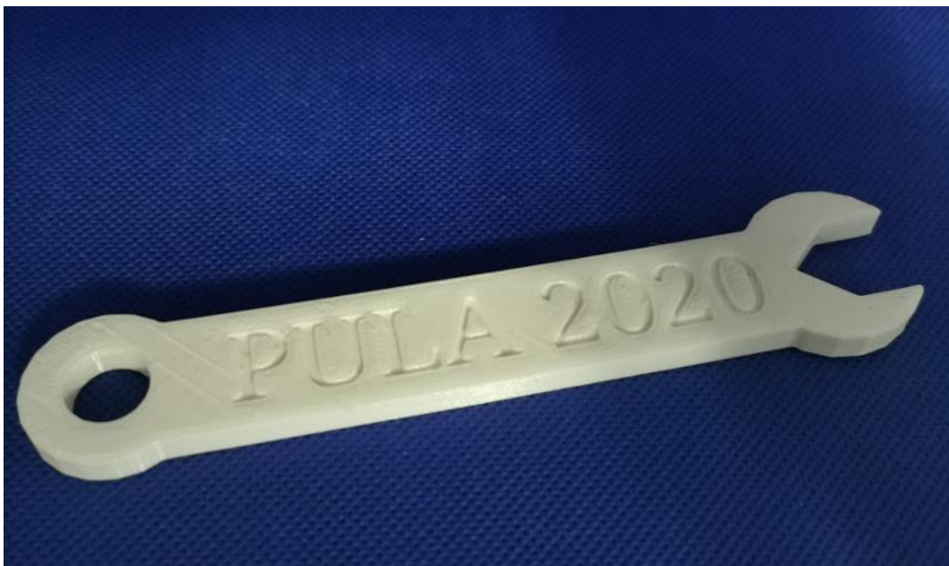
Slika 67. 3D printani prototip nakon završne obrade
