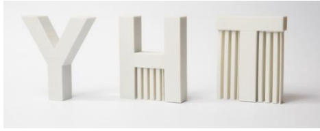
Slika 25. Potporna struktura kod FDM postupka
