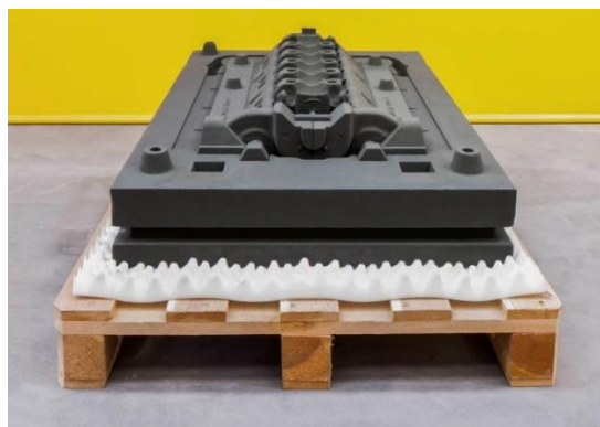
Slika 13. Izrada kalupa velikih dimenzija 3DP postupkom
