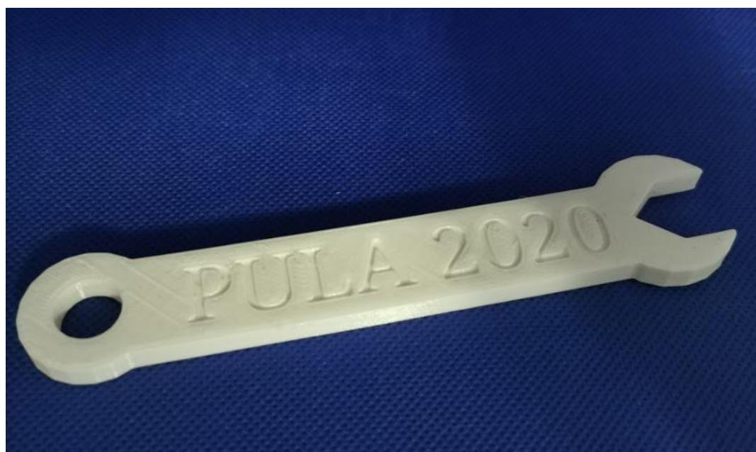
*Slika 67. 3D printani prototip nakon završne obrade*
