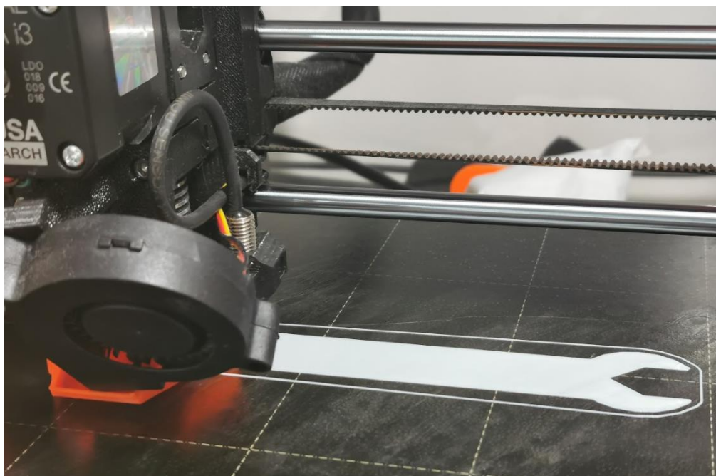
Slika 65. 3D printanje stopostotne ispune
