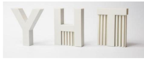
Slika 25. Potorna struktura kod FDM postupka
