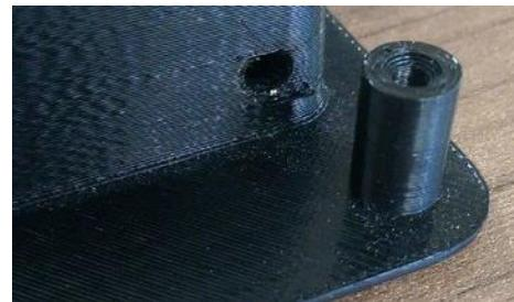
Slika 26. Izrada prvrta kod FDM postupka
