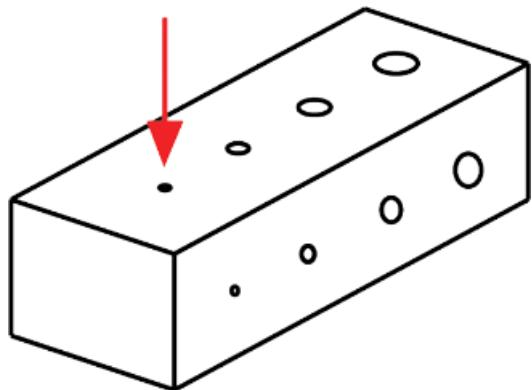
Slika 30. Preporučeni minimalni promjer provrta kod SLA postupka
