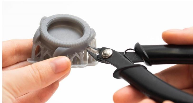
Slika 7. Uklanjanje potporne strukture
