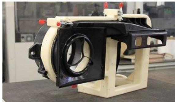
*Slika 18. Primjena aditivne tehnologije prilikom brze izrade prototipa*
