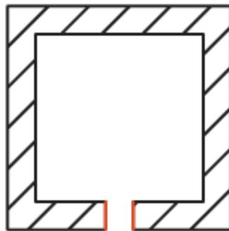
Slika 34. Otvori za izlaz praha kod SLS postupka
