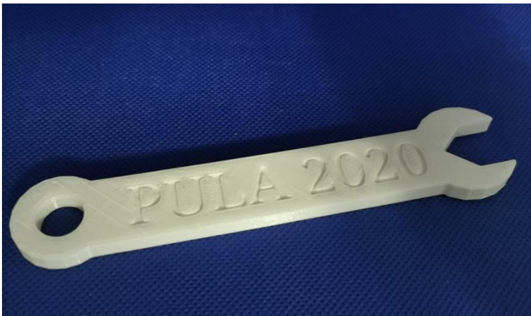
Slika 67. 3D printani prototip nakon završne obrade
