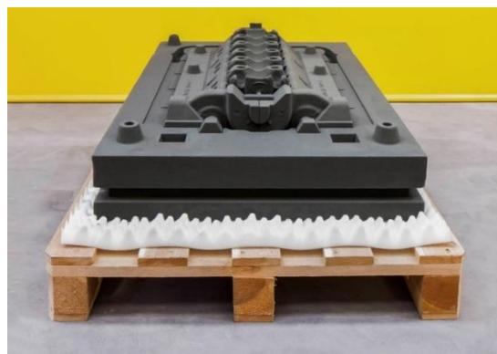
Slika 13. Izrada kalupa velikih dimenzija 3DP postupkom
