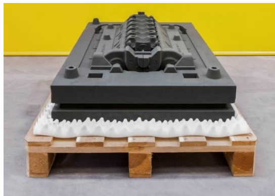
Slika 13. Izrada kalupa velikih dimenzija 3DP postupkom
