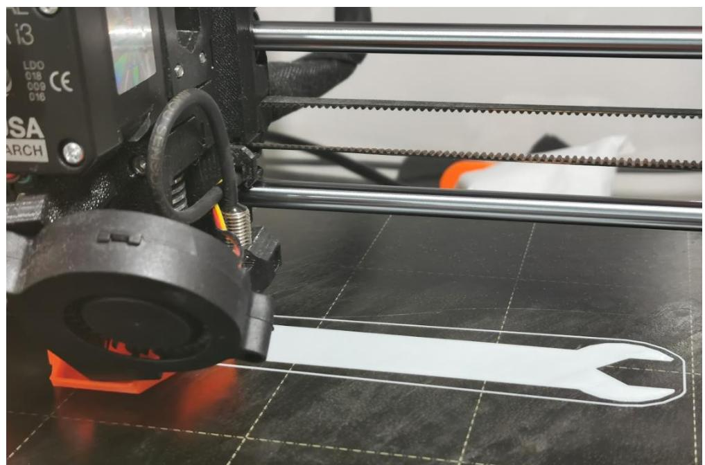
Slika 65. 3D printanje stopostotne ispune
