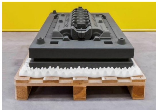
Slika 13. Izrada kalupa velikih dimenzija 3DP postupkom
