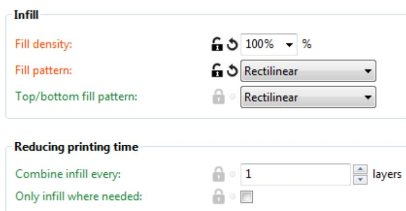
Slika 55. Odabir ispune 3D printanog objekta
