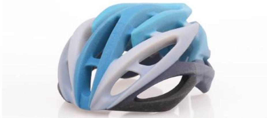
Slika 9. 3D objekt izrađen PolyJet postupkom
