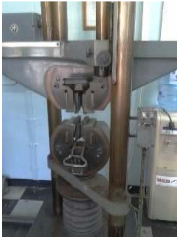
Slika 6.8.: Kidalica- Uređaj za vlačno ispitivanje [13]
