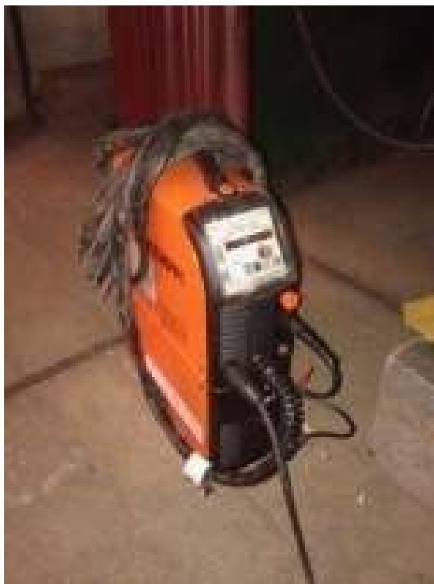
Slika 6.3. Uređaj za TIG zavarivanje [13]
