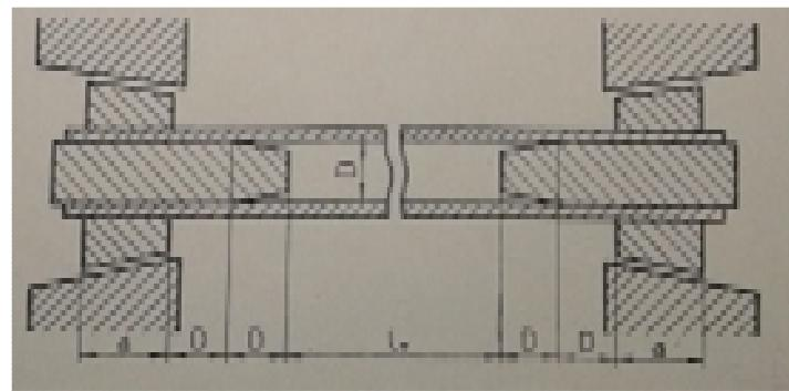
*Slika 6.10.: Prikaz ispitne cijevi pričvršćene na čeljusti kidalice na početku vlačnog ispitivanja [9]*
