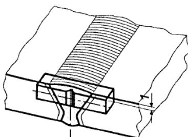
*Slika 4.4.1.: Epruveta za ispitivanje udarnog rada loma [3]*
