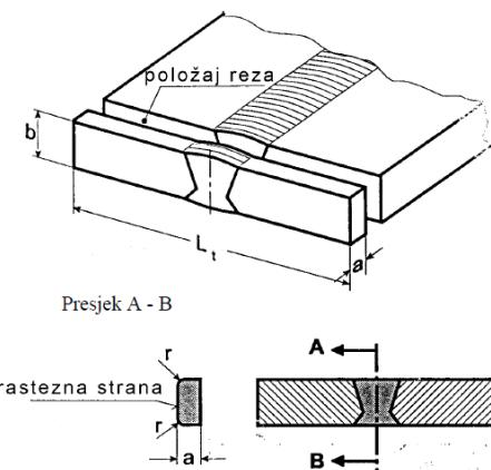
Slika 4.2.3.: Epruveta za ispitivanje savijanjem [3]
