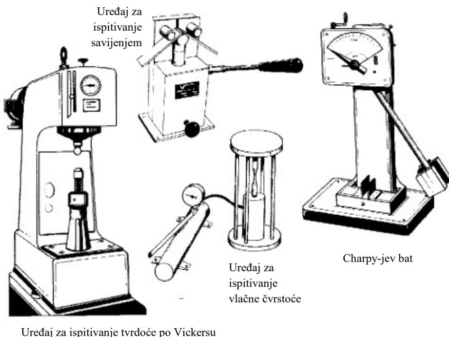
Slika 4.1.: Uređaji za ispitivanja zavarenih spojeva primjenom razaranja [12]
