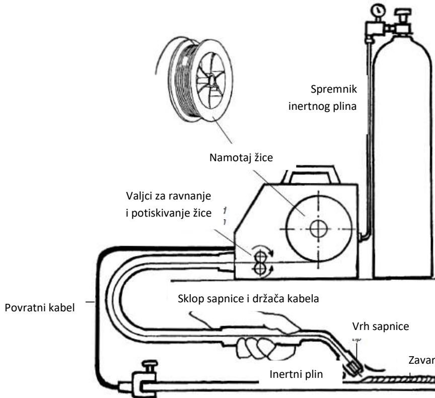
Slika 2.2.2.: Oprema za zavarivanje MIG postupkom [10]
