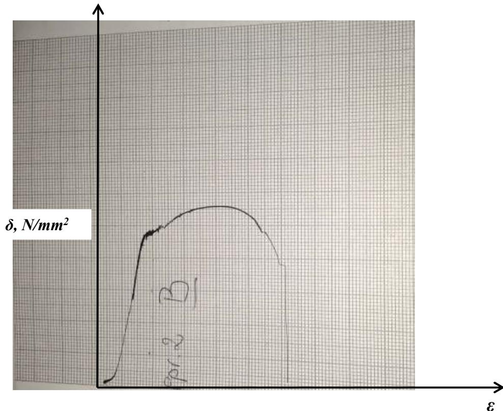
Slika 6.15.: Dijagram naprezanja ispitnog uzorka B djelovanjem sile [13]
