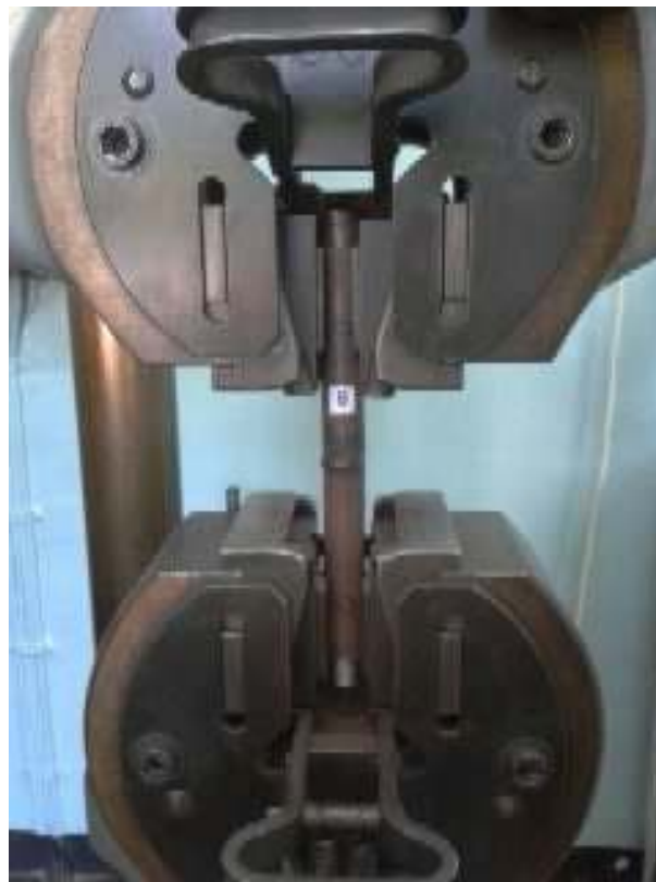
Slika 6.11.: Postavljanje ispitnog uzorka A i uzorka B u čeljusti uređaja za vlačno istezanje i početak istezanja [13]
