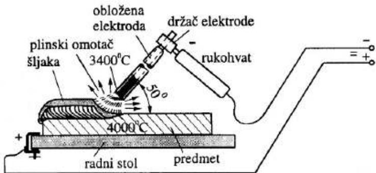
Slika 2.1.1.: Glavni elementi REL postupka zavarivanja [1]
