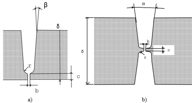
Slika 2.6.5.: "U" žljeb, a) jednostruki b) dvostruki [10]
