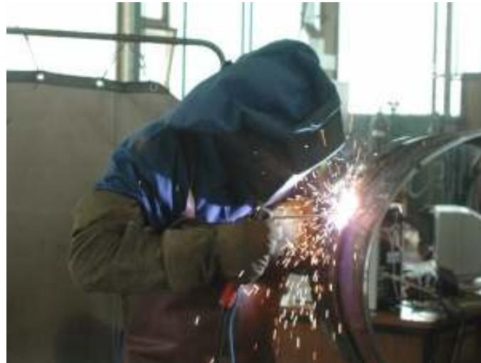
*Slika 2.1.3.: Zavarivanje cijevi REL postupkom [12]*
