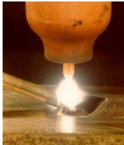
Slika 2.4.2.: Prikaz zavarivanja materijala TIG postupkom [7]
