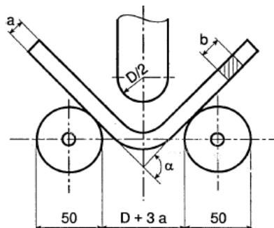
Slika 4.2.2.: Shematski prikaz uređaja za ispitivanje savijanjem [3]
