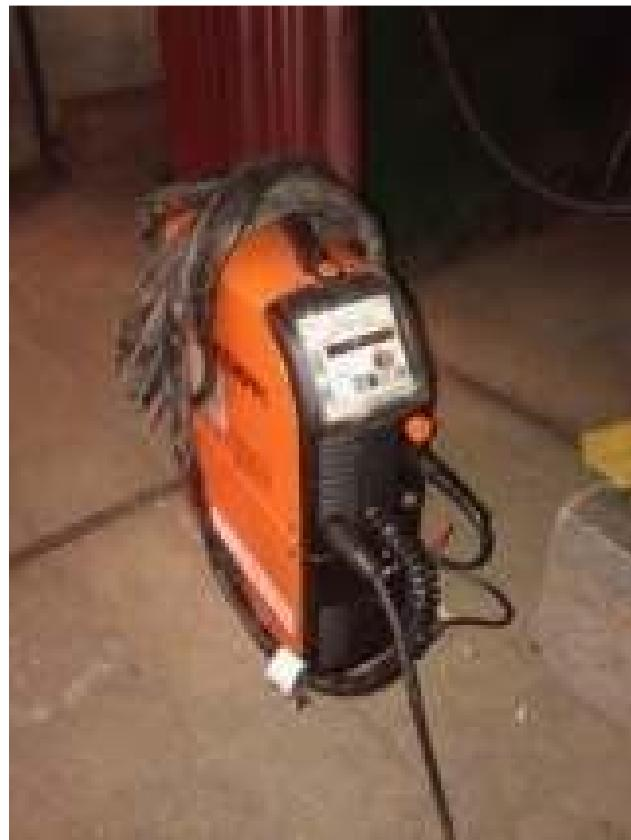
Slika 6.3. Uređaj za TIG zavarivanje [13]
