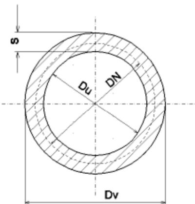
Slika 3.4.1.: Primjer nazivnog promjera za čelične bešavne cijevi [12]
