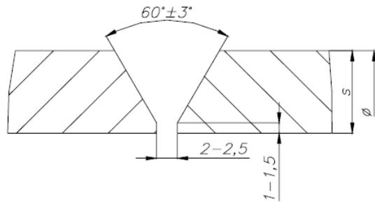
*Slika 2.1.2.: Pripremljeni žlijeb za zavarivanje [7]*
