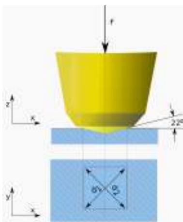
*Slika 4.3.1.: Shematski prikaz ispitivanja tvrdoće Vickersovom metodom [7]*
