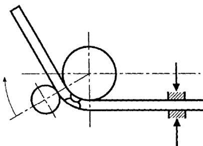
Slika 4.2.4.: Naprava za bočno ispitivanje savijanjem [3]
