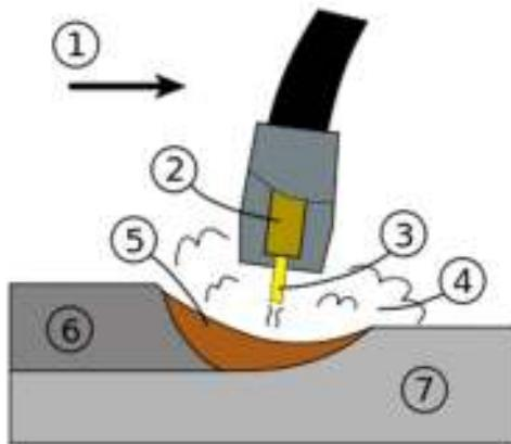
*Slika 2.3.1.: Prikaz zavarivanja MAG postupkom [10], 1.smjer zavarivanja, 2.vodilica elektrode, 3. elektroda, 4. smjesa plina, 5. mješavina rastaljenog metala, 6.dubina zavara, 7.osnovni materijal*
