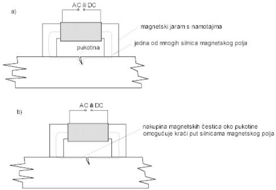
Slika 2.9.2.: Princip ispitivanja zavarenog spoja magnetskom kontrolom [12]
