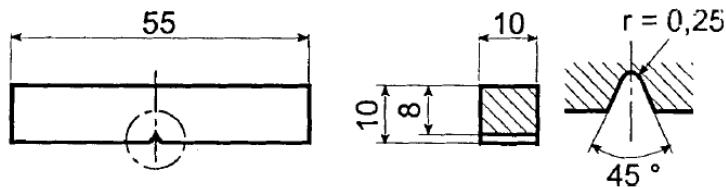
Slika 4.4.2.: Dimezije epruvete za ispitivanje udarnog rada loma [3]
