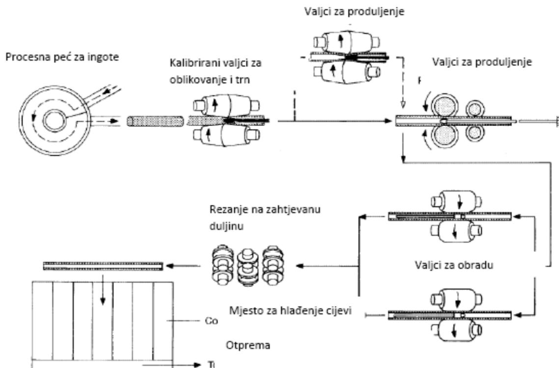
Slika 3.1.1.: Shematski prikaz proizvodnje čeličnih bešavnih cijevi
