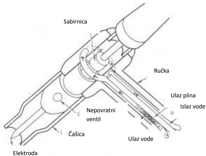
Slika 2.4.1.: Dijelovi držača (tkz. zavarivačkog pištolja) volframove elektrode [10]
