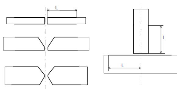
Slika 2.6.7.: Pripremljene površine radnog komada za zavarivanje [7]
