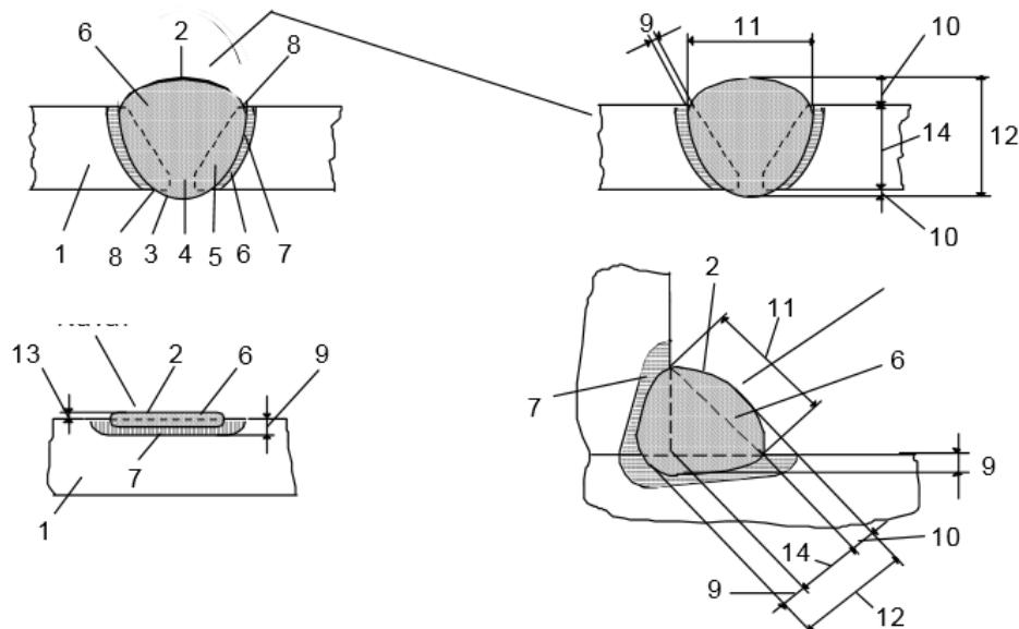
Slika 2.6.1.: Osnovni elementi žljeba i zavarenog spoja [7]
