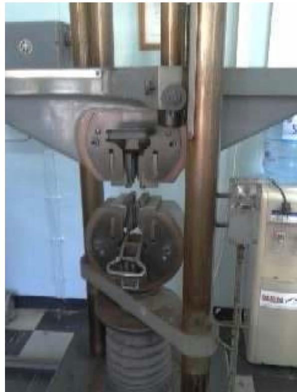
Slika 6.8.: Kidalica- Uredaj za vlačno ispitivanje [13]
