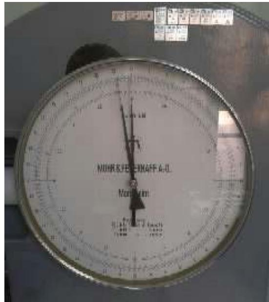
Slika 6.13.: Mjerni uređaj za mjerjenje sile  $F$  koja djeluje na ispitne uzorke A i B [13]
