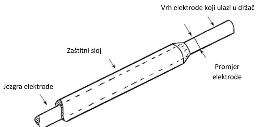
Slika 2.5.1.: Sastavni dijelovi elektrode za REL postupak zavarivanja [12]
