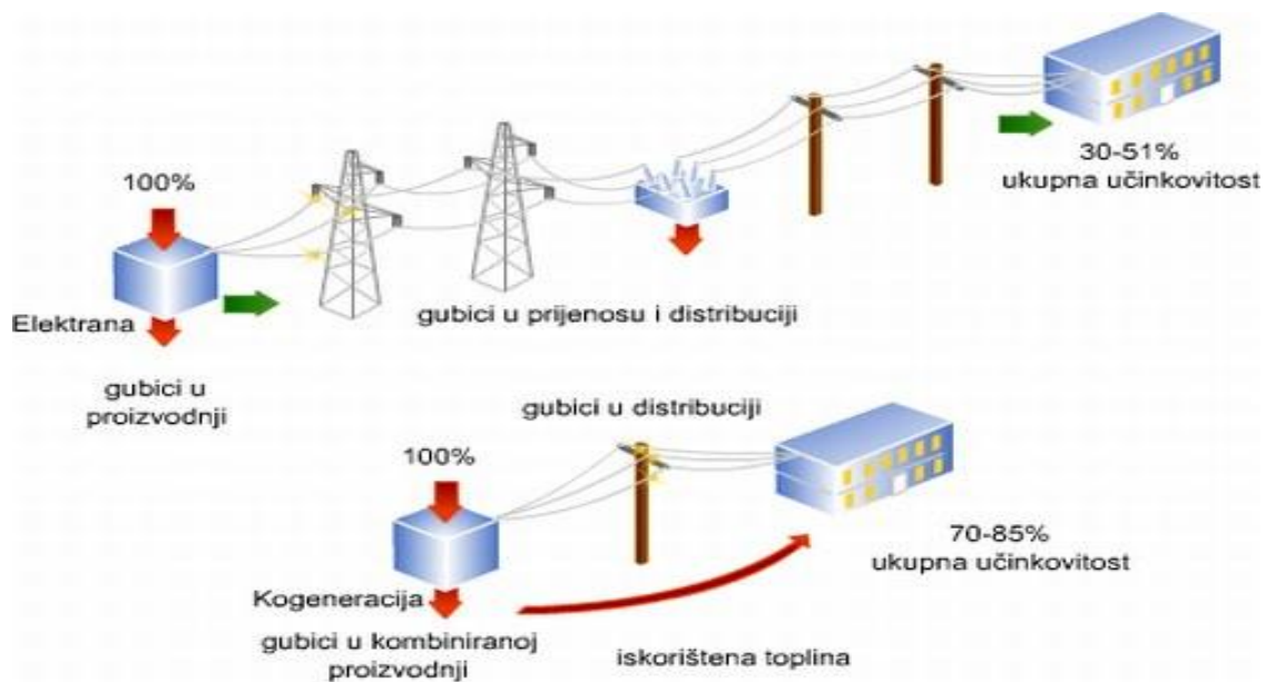
Slika 12. Usporedbe energetske učinkovitosti
