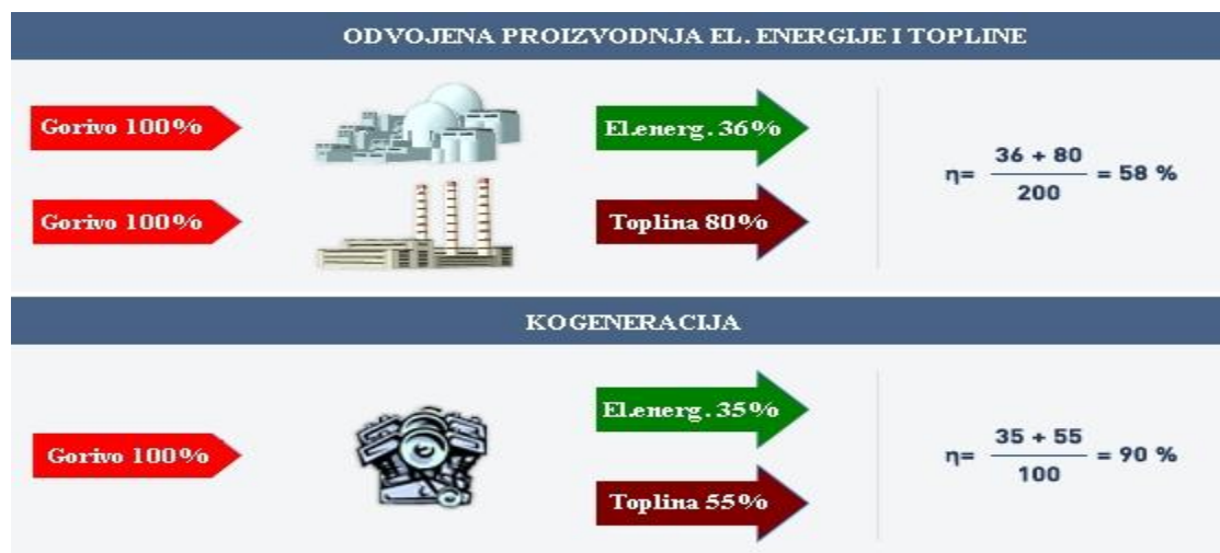
Slika 11. Ukupni stupanj djelovanja u proizvodnji električne energije i topline u kogeneracijskim postrojenjima
