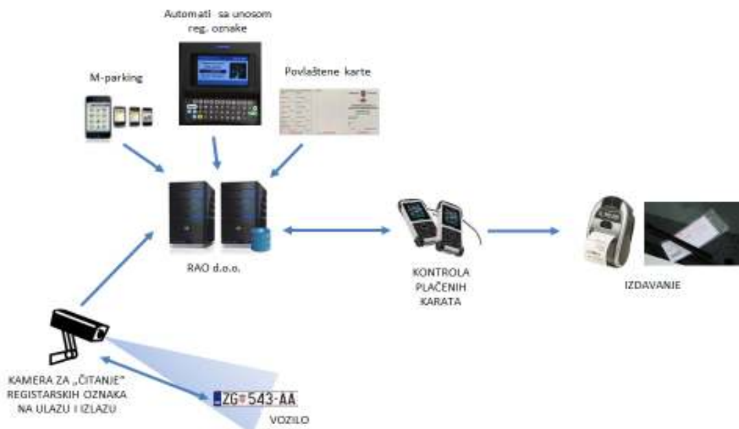
Slika 17: Shema sustava za automatsko čitanje registarskih oznaka
