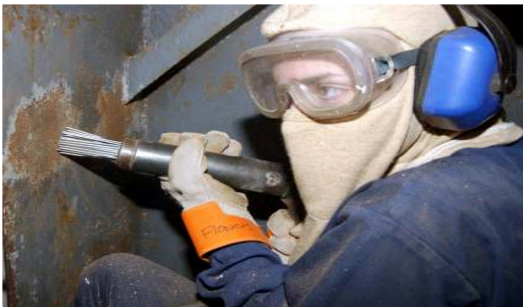
Slika 15: Uklanjanje korozivnih produkata na brodu
