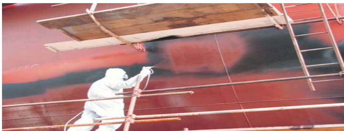
Slika 16: Nanošenje premaza špricanjem u Brodogradilištu Uljanik
