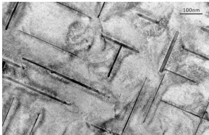
Slika 6. Legura aluminija s 4% bakra, a mikrostruktura pokazuje taloženje bakra (tamni dijelovi) unutar osnovne aluminija.
