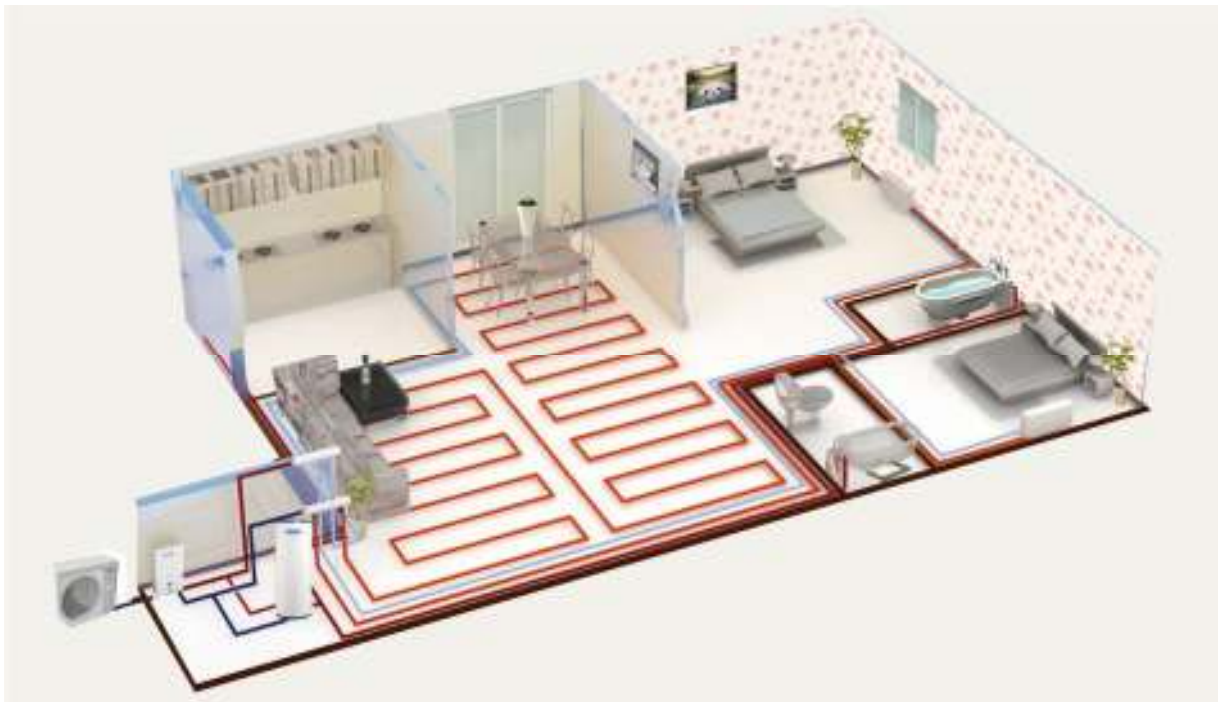
Slika 8. Primjena dizalice topline
