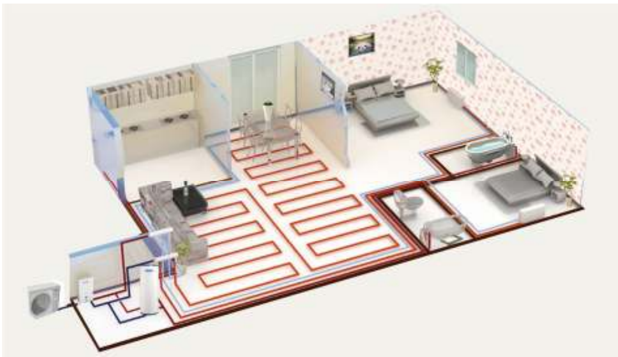
Slika 8. Primjena dizalice topline
