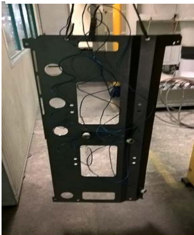
Slika 42. instrument za mjerenje temperatura na limu
