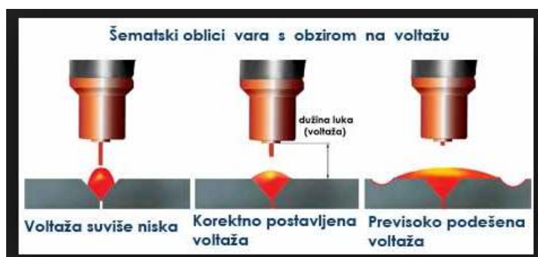
Slika 62 Veza voltaže i oblika vara
