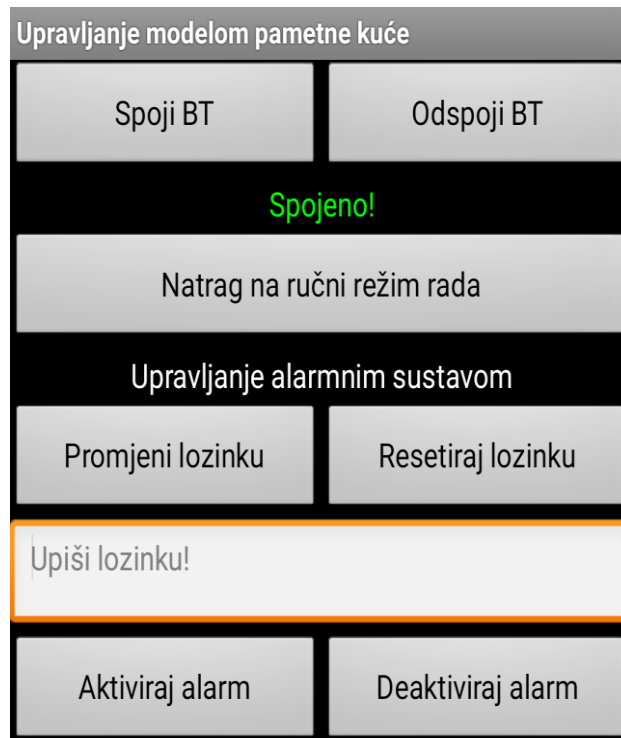
Slika 59. – Dizajnerski dio za Upravljanje alarmnim sustavom
