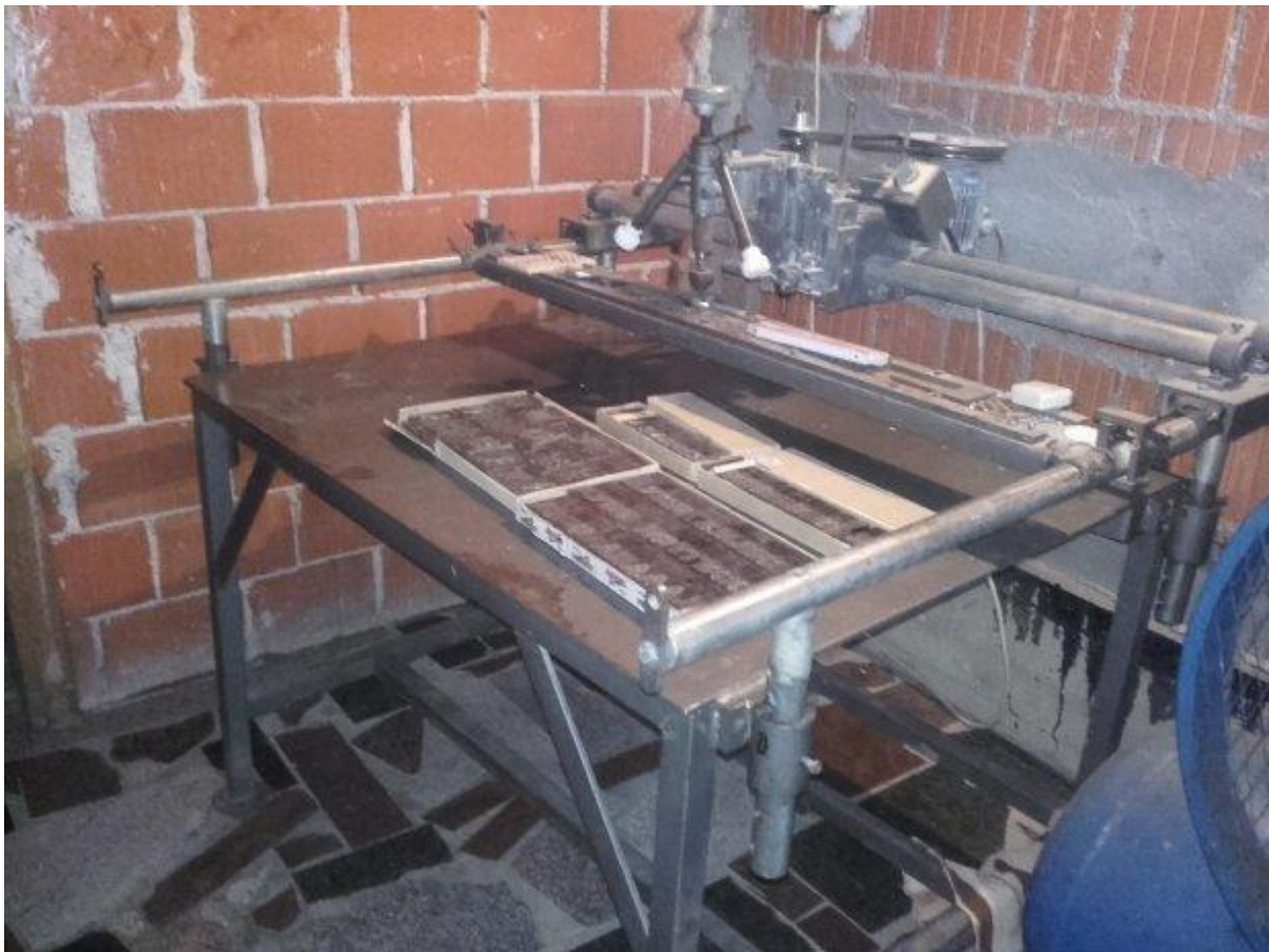
Slika 4: Ručni stroj za graviranje
