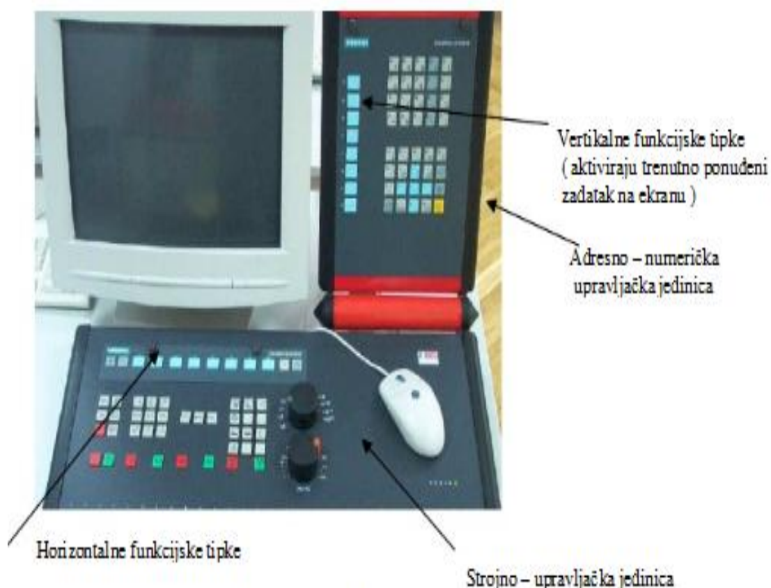
Slika 20: Upravljačka jedinica CNC stroja
