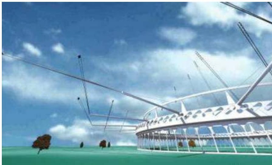
Slika 21: KiteGen kao "vrtuljak" za primjenu na kopnu
