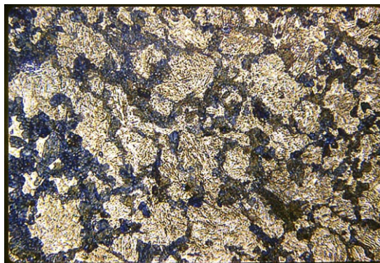
Slika 43. Metalografski snimak podpovršinskog – prijelaznog sloja
