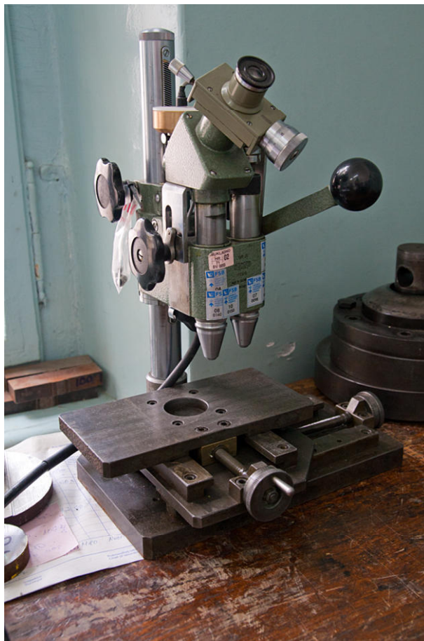
Slika 41. Uređaj za mjerenje tvrdoće Vickers metodom
