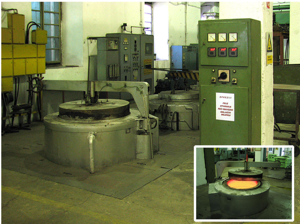
Slika 21. Peć za zagrijavanje pougljičenih obradaka
