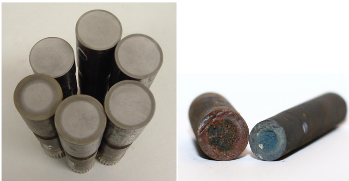
Slika 33. Probne epruvete za kontrolu pougljičavanja
