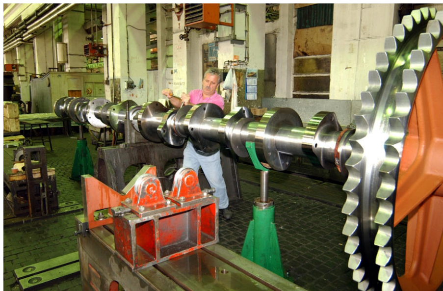
Slika 6. Sastavljanje bregaste osovine
