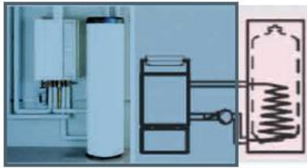
Slika 32. Centralna priprema tople vode sa kotlom i indirektno grijanim spremnikom
