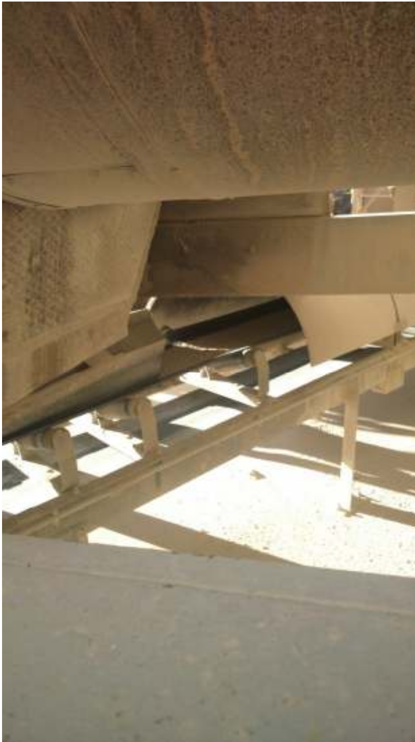
Slika 9.: Gumeni trakasti transporter usitnjenih frakcija
