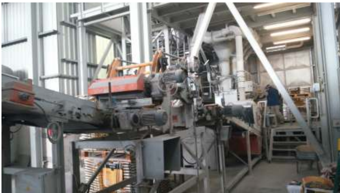
Slika 25.: Trakasti transporter vodi u sustav za paletiziranje
