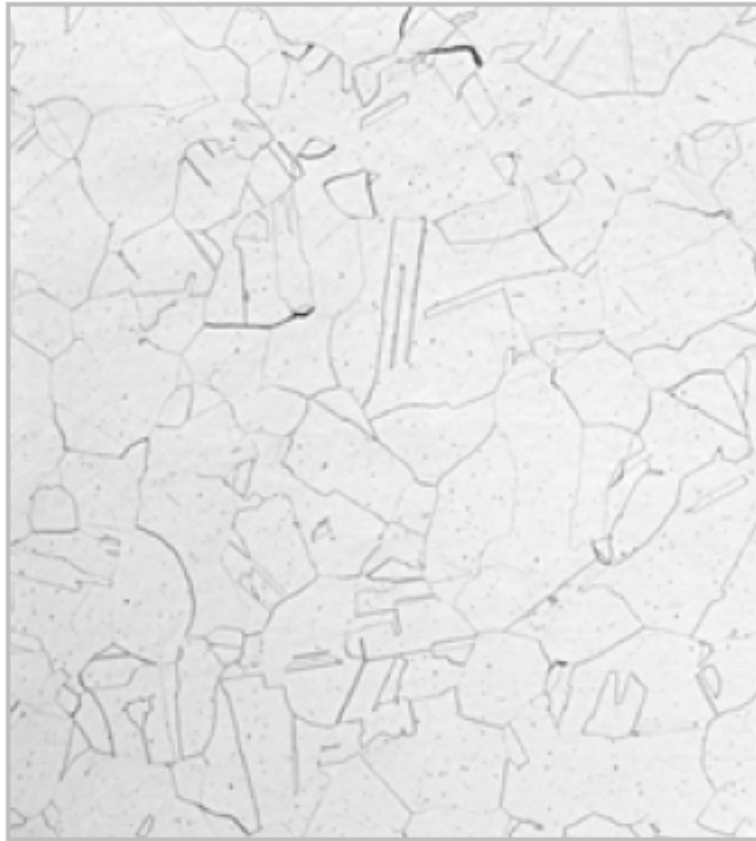
Slika 2: mikrostruktura austenitnog nehrđajućeg čelika (Rede 2012)
