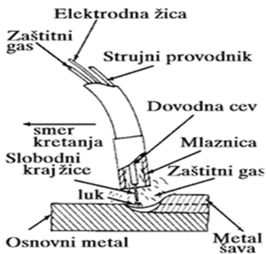
Slika 20: Elektrolučno zavarivanje topljivom elektronom u zaštiti plina
