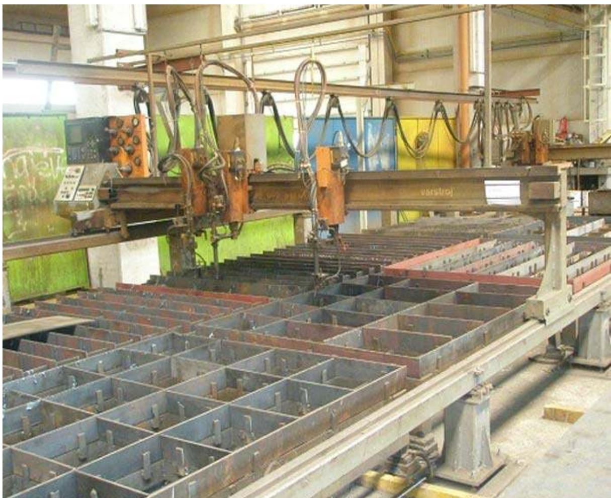
Slika 8: Pantograf za rezanje metala
