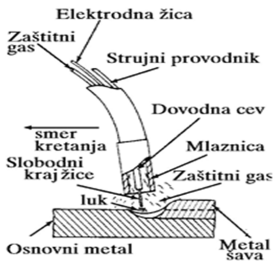
Slika 20: Elektrolučno zavarivanje topljivom elektronom u zaštiti plina
