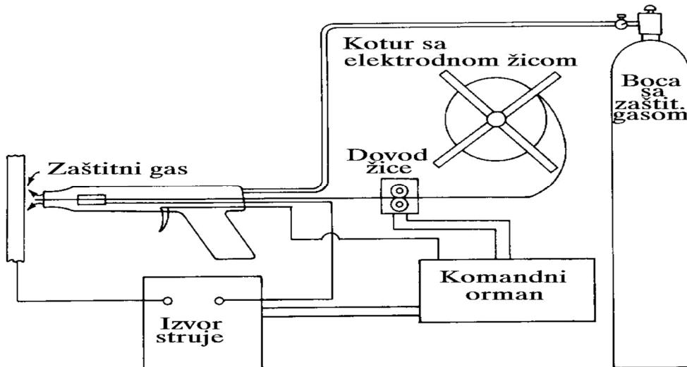
Slika 19: Shema elektrolučnog zavarivanja topljivom elektrodom u zaštitnom plinu
