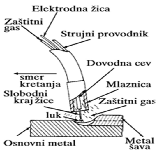
Slika 20: Elektrolučno zavarivanje topljivom elektronom u zaštiti plina
