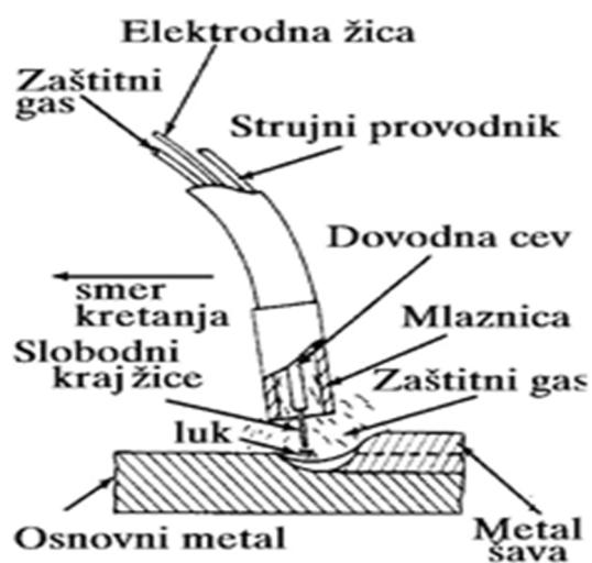
Slika 20: Elektrolučno zavarivanje topljivom elektronom u zaštiti plina
