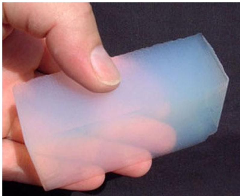
Slika 11: Blok Aerogel® izolacije
