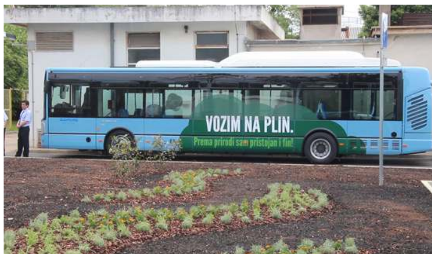
Slika 36: Autobus Iveco sa pogonom na SPP u Rijeci
