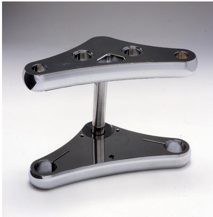
Slika 14 Jaram motocikla na koji se ugrađuju vilice i upravljač motocikla
