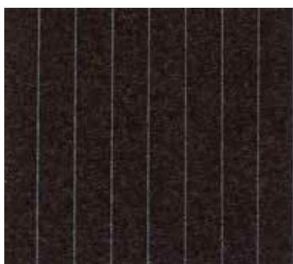
Slika 11.: Solarna ćelija od bakar-indij-diselenida (CIS)
