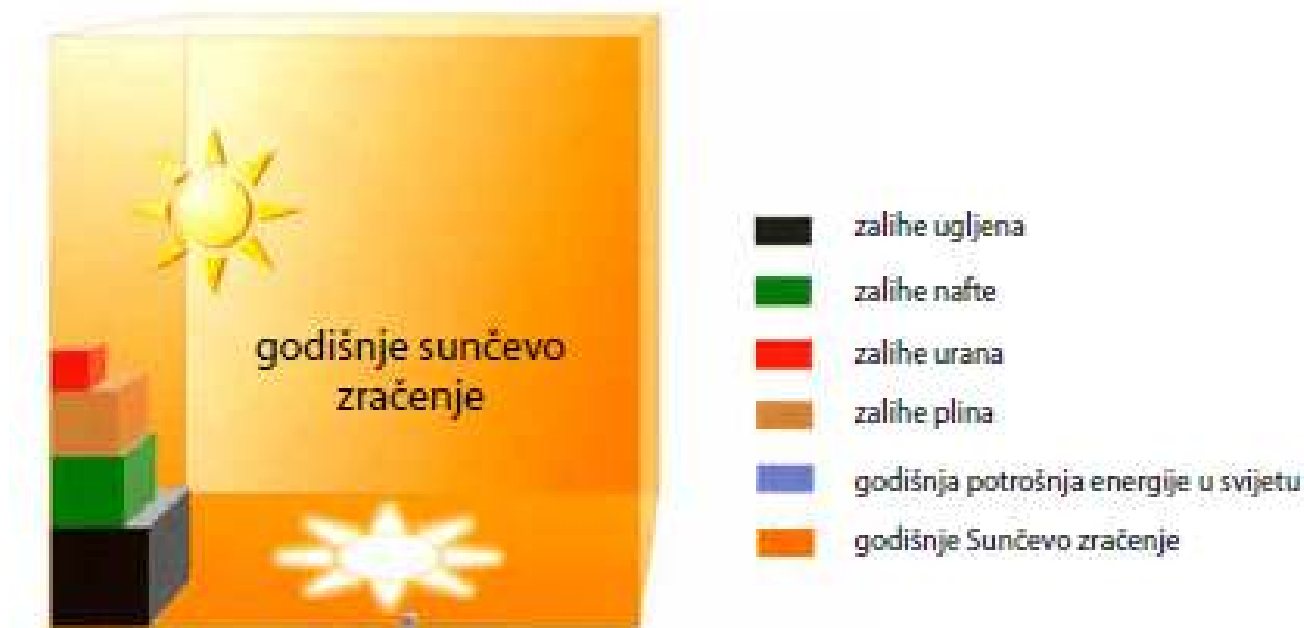
Slika 7.: Godišnje sunčevo zračenje na površini zemlje u usporedbi sa zalihama
