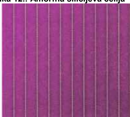
Slika 12.: Amorfna silicijeva ćelija
