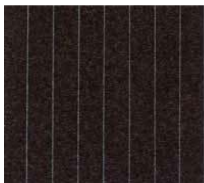
Slika 11.: Solarna ćelija od bakar-indij-diselenida (CIS)
