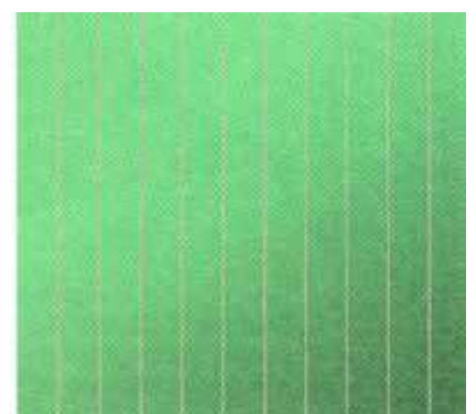
Slika 13.: Solarna ćelija od kadmijeva telurida (CdTe)
