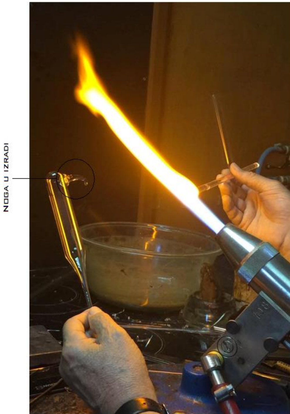
Slika 5.21. Formiranje prvobitnog izgleda noge
