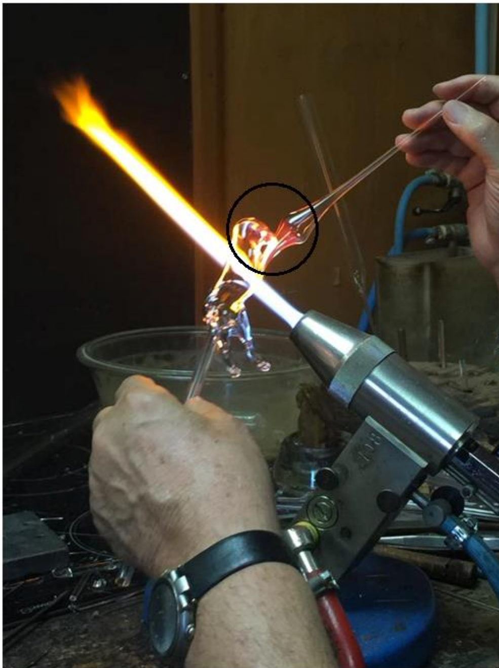
Slika 5.26 Odvajanje staklene cijevi i formiranje modela glave
