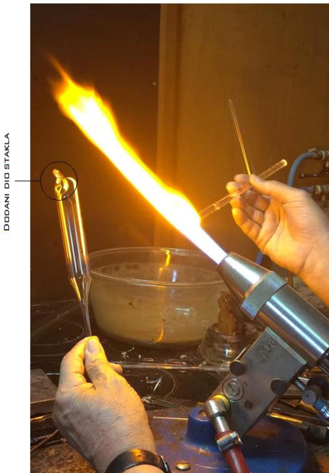
Slika 5.20. Taljenje staklene šipke
