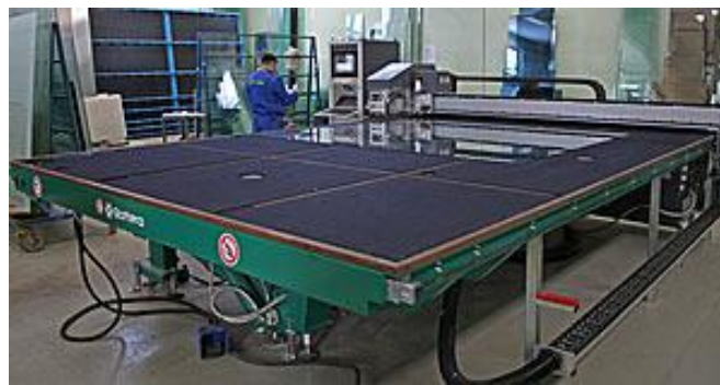
Slika 3.2. Stol za rezanje stakla
