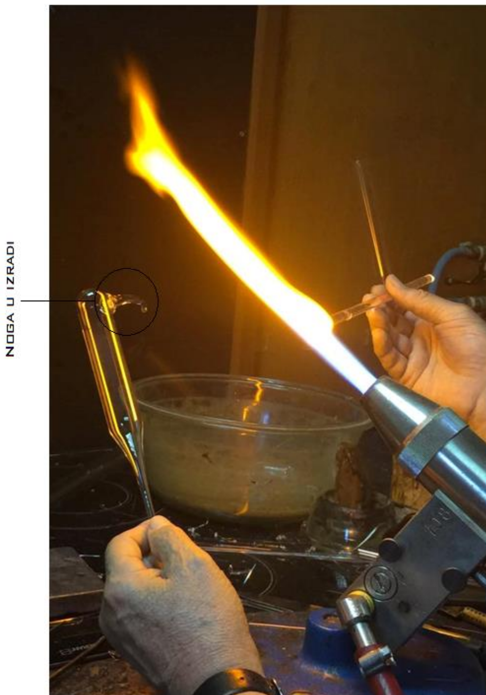
Slika 5.21. Formiranje prvobitnog izgleda noge
