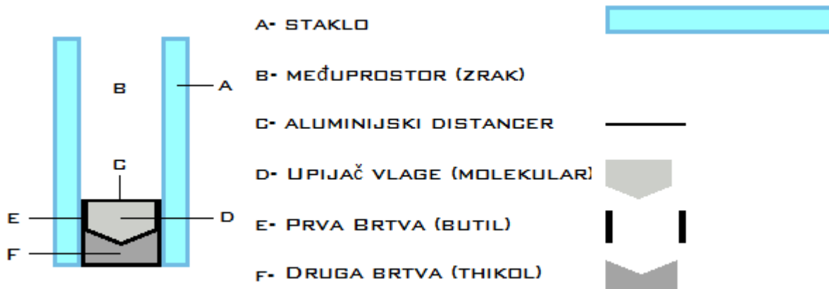
Slika 4.7. Struktura izolacijskog stakla
