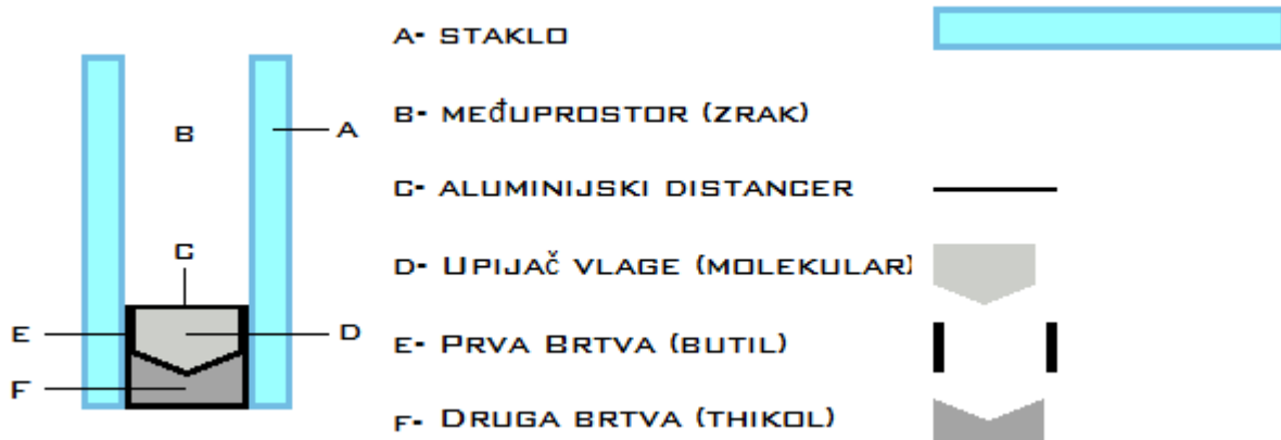
Slika 4.7. Struktura izolacijskog stakla
