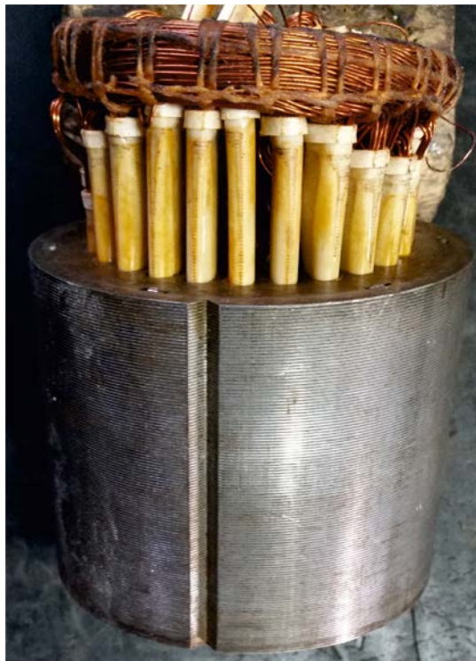
Slika 22 Izvlačenje namota iz statorskog paketa
