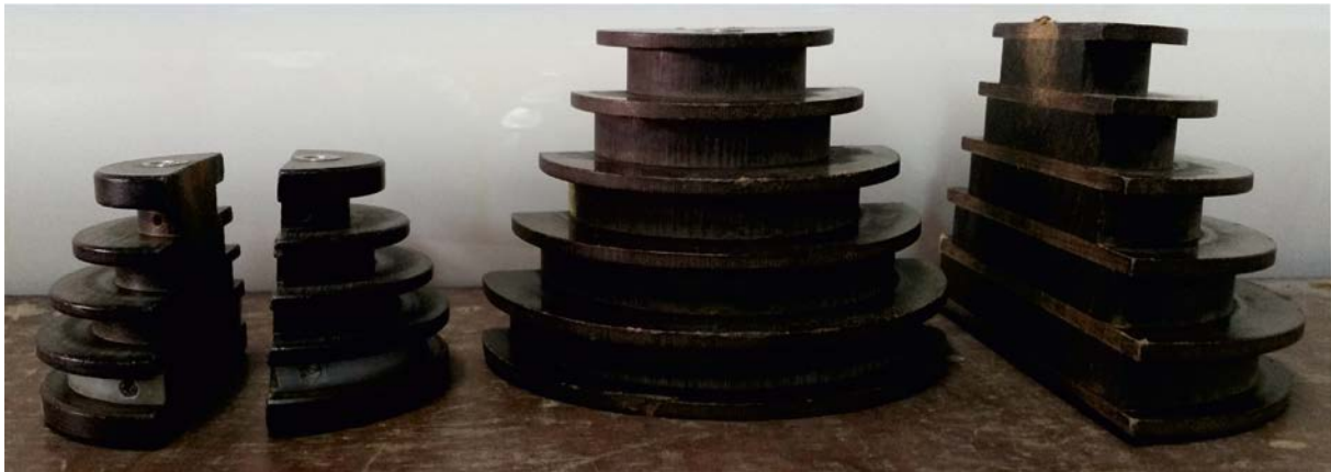
Slika 35 Radionički kalupi za namatanje koncentričnih svitaka
