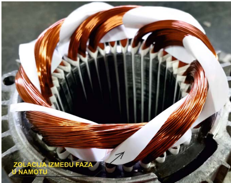
Slika 24 Čeona strana namota sa međufaznom izolacijom
