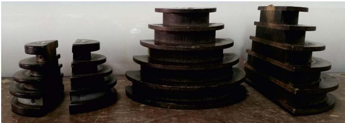
Slika 35 Radionički kalupi za namatanje koncentričnih svitaka
