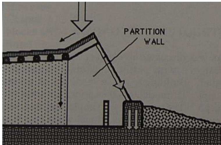
**Slika 36. Prikaz sila koje se javljaju i raspodjele istih kod izrade ostaklenjenog južnog dijela Earthshipa**
