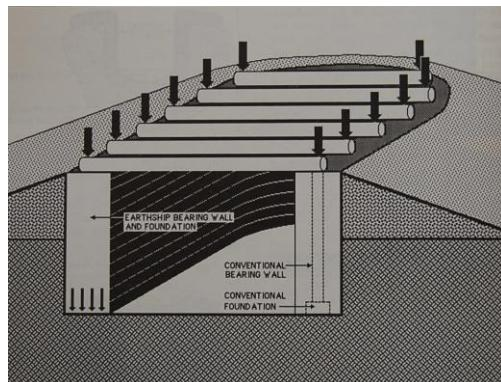
**Slika 35. Prikaz postavljenih greda nosive konstrukcije krova Earthshipa**
