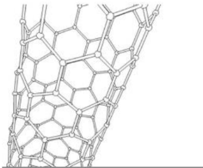
Slika 12. Ugljična nanocijev
