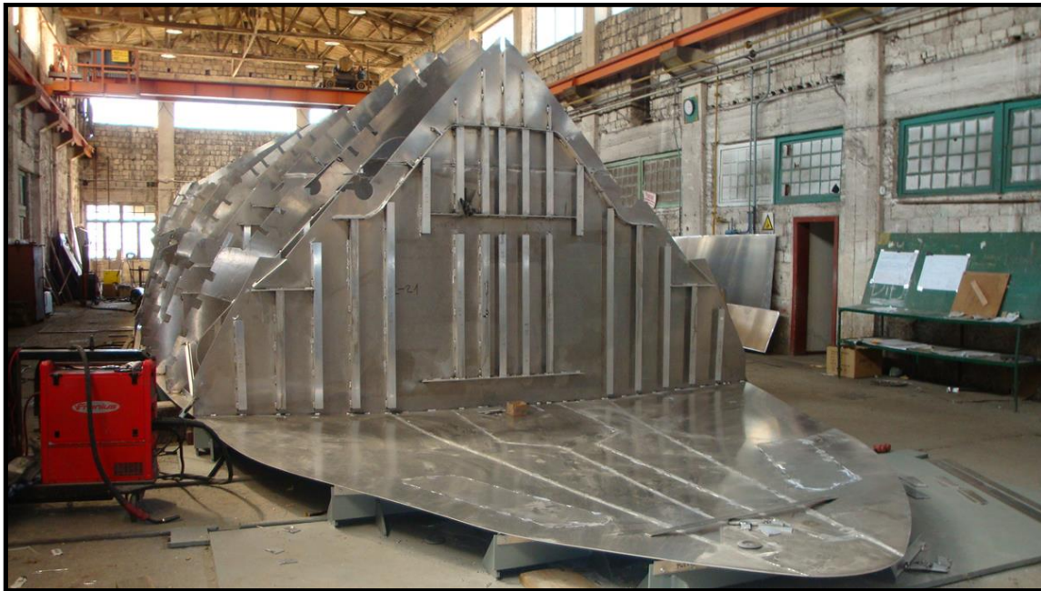
Slika 6: Gradnja broskog trupa na glavnoj palubi
