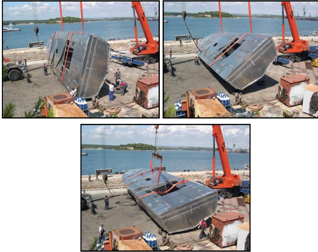
Slika 7: Rotiranje brodskog trupa
