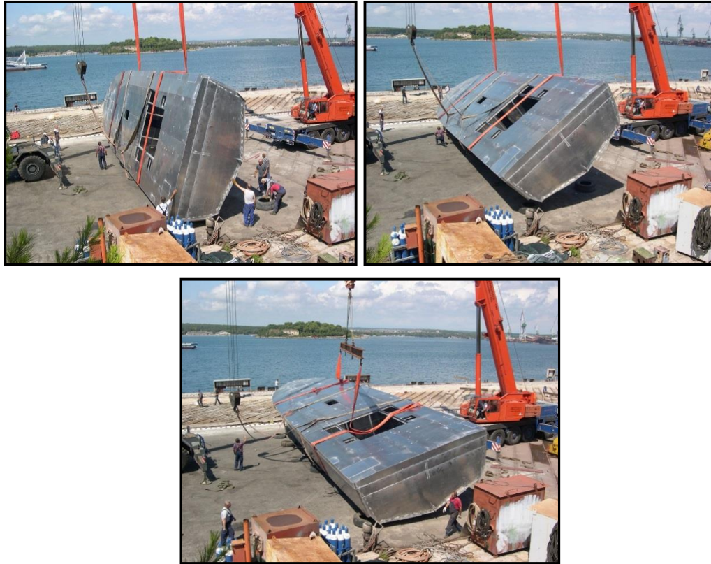
Slika 7: Rotiranje brodskog trupa
