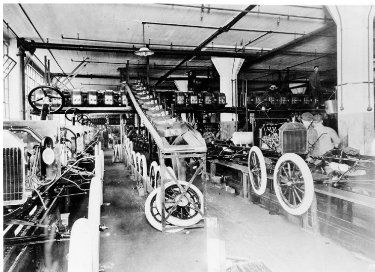
Slika 2. Primjer pokretne trake koja je nesigurna za rad čovjeka
