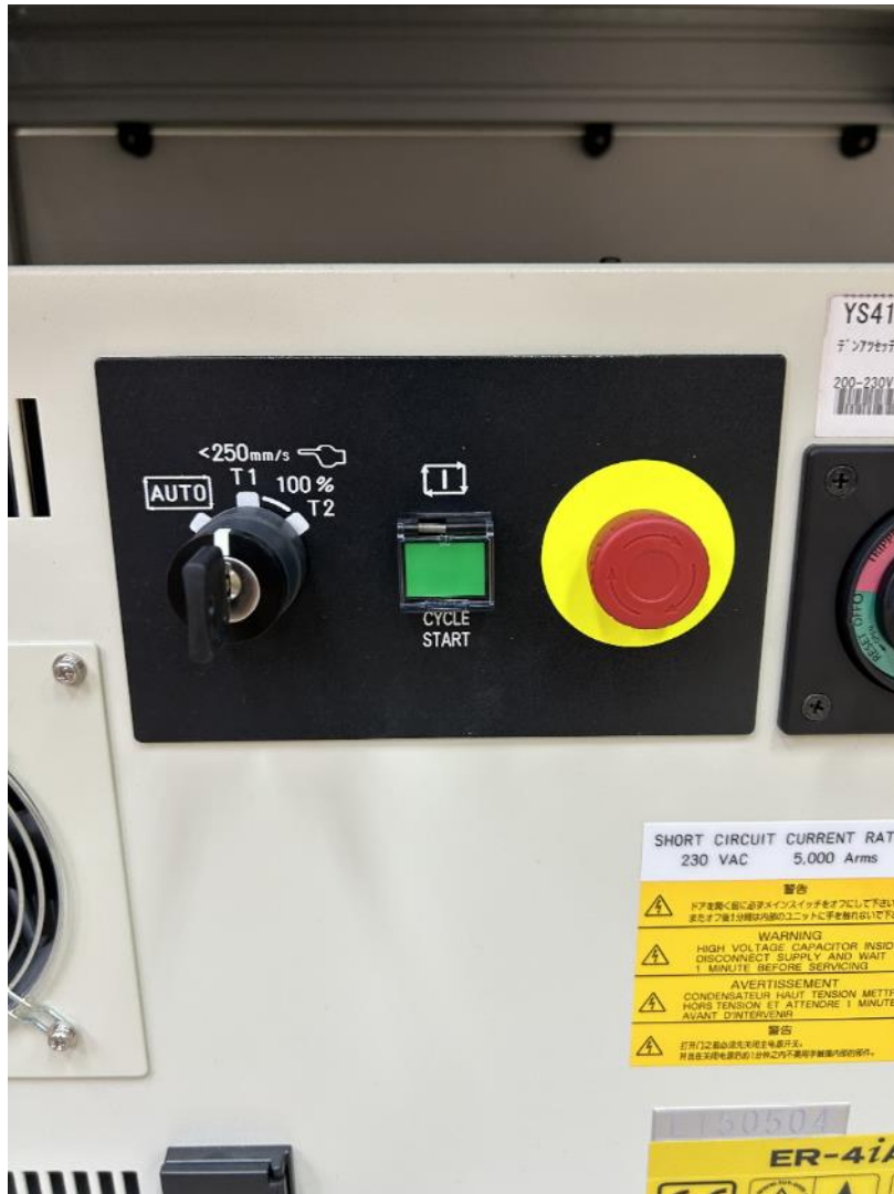
Slika 13. Prikaz prekidača koji odabire u kojem stanju robot radi Izvor: autor
