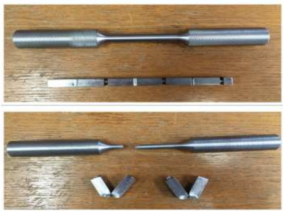
Slika 7. Epruvete prije i nakon ispitivanja.
