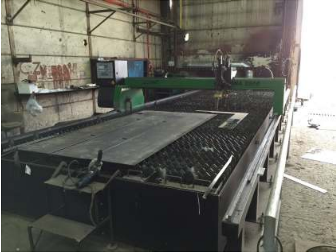
Slika 11. Prikaz CNC stroja za rezanje plazmom.
