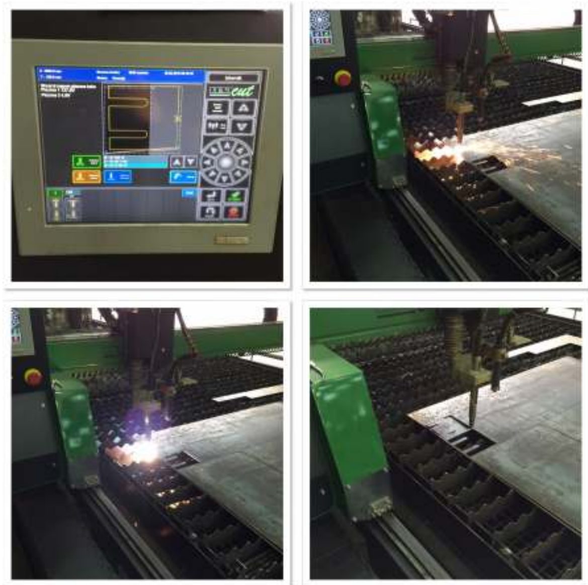
Slika 12. Prikaz rezanja lima na CNC stroju.
