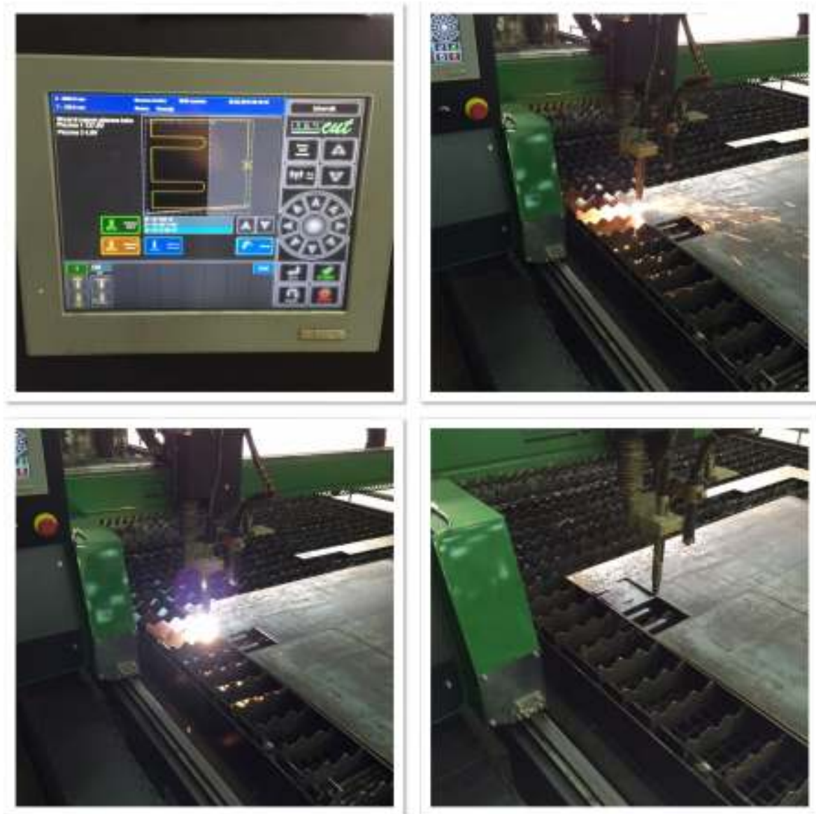
Slika 12. Prikaz rezanja lima na CNC stroju.
