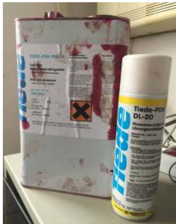
Slika 16. Prikaz penetranta i razvijaa.
