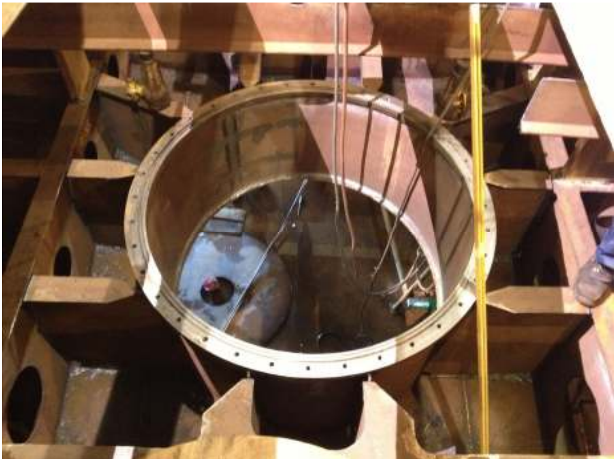
Slika 20. Strukturna cijev propulzora.
