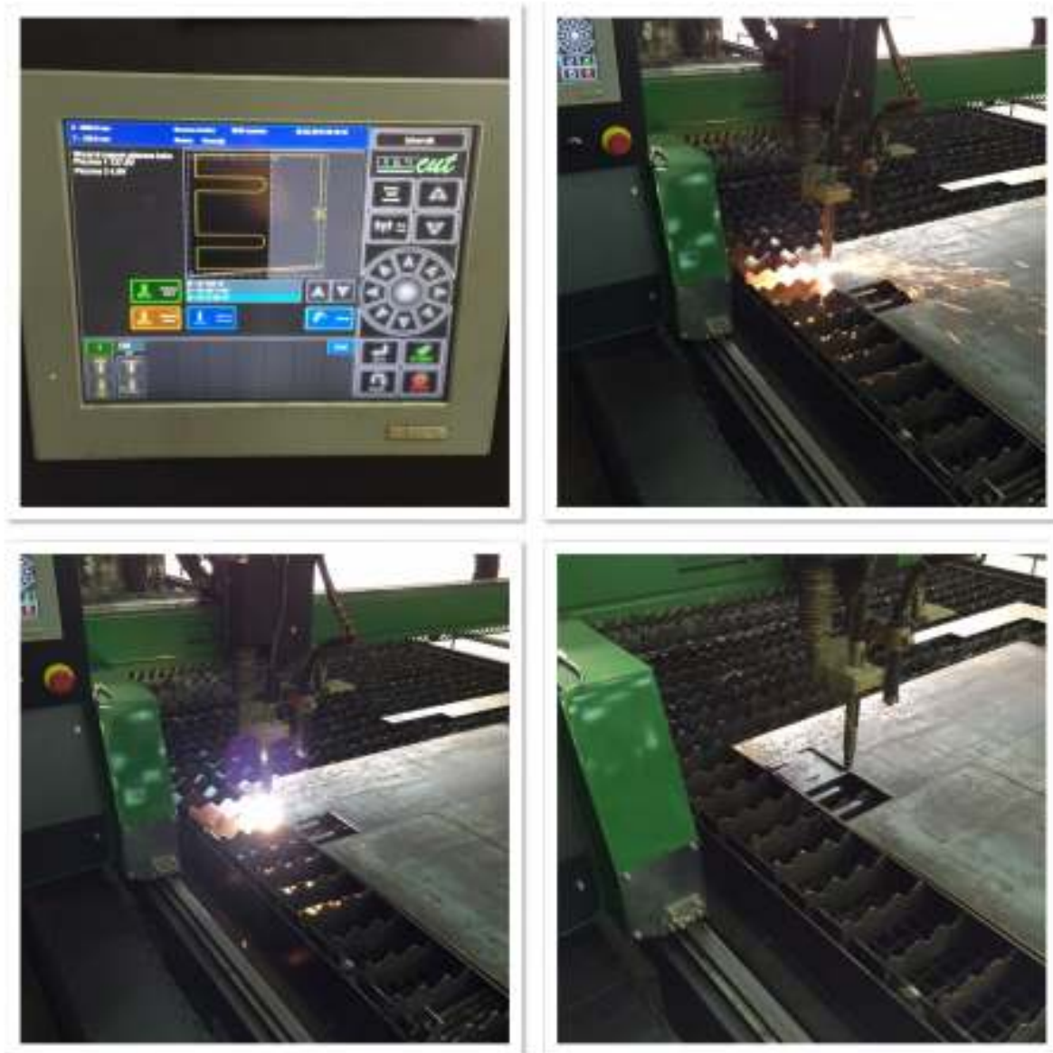
Slika 12. Prikaz rezanja lima na CNC stroju.
