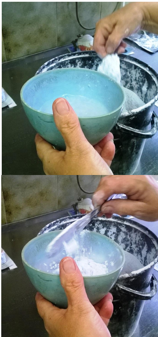
Slika 4.15. Miješanje moldana i vode inox-špatulom
