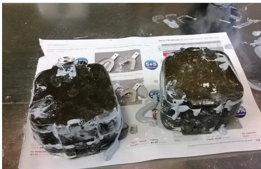
Slika 4.49. Zatvorene kivete za vrijeme čekanja stvrdnuća gipsa
