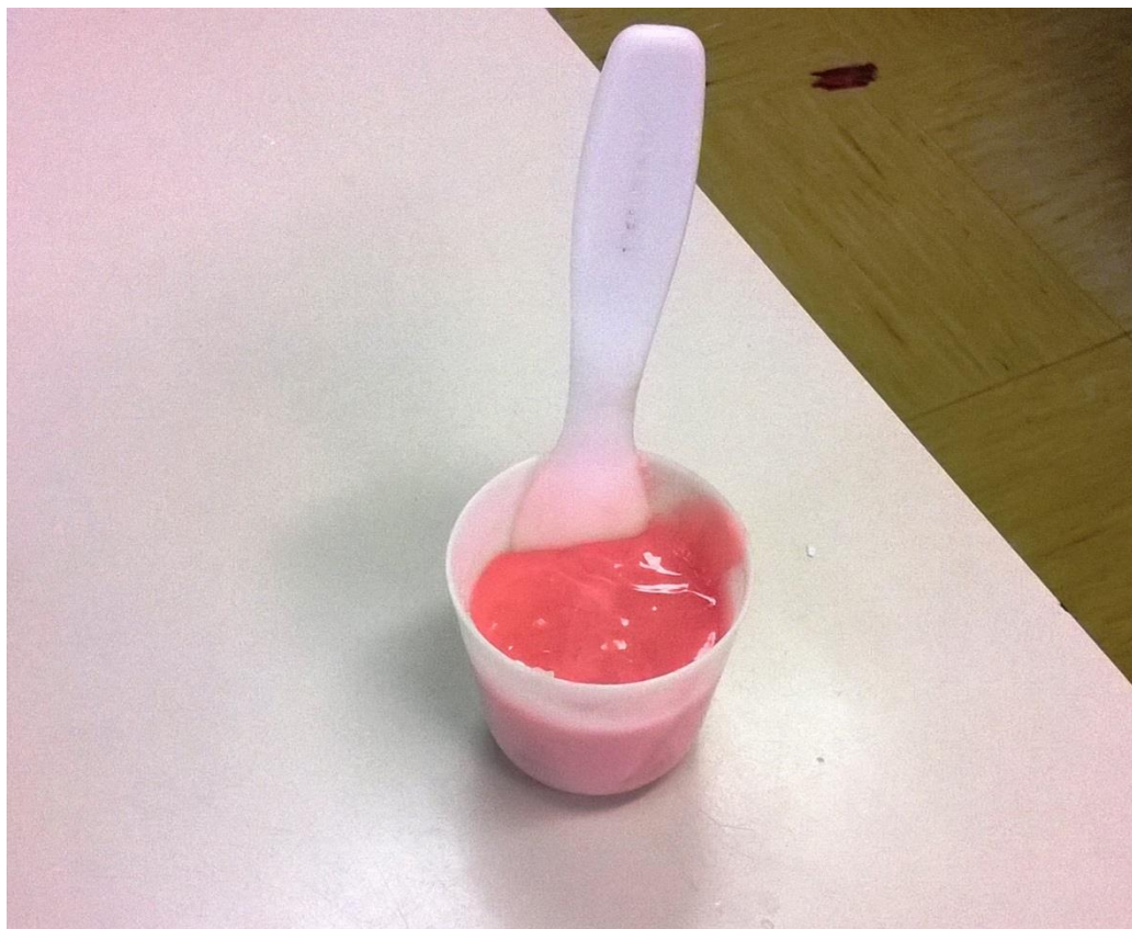
Slika 4.56. Radna faza akrilatne smjese – akrilatna smjesa se ne lijepi za stijenke posude, sjajne je površine i na izgled homogena
