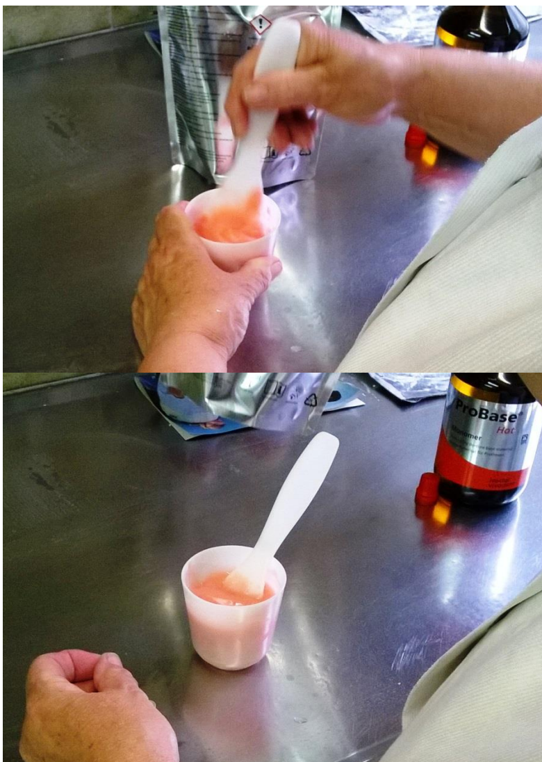
Slika 4.55. Miješanje akrilatne smjese ravnom plastičnom lopaticom (gore) i dobivena ljepljiva akrilatna smjesa (dolje)
