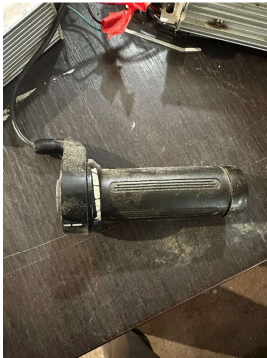
Slika 18. Vanjski potenciometar, Slika: Autor
