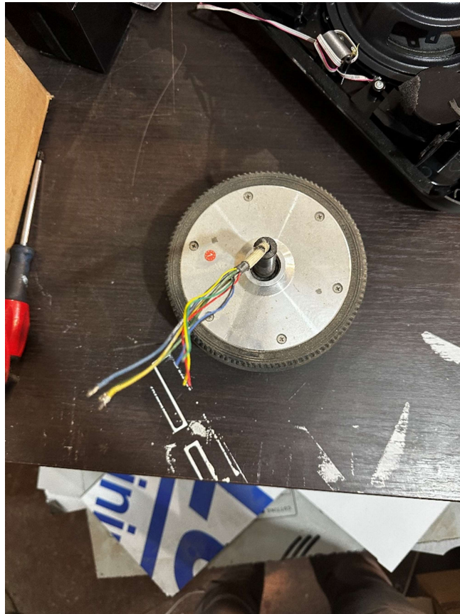
Slika 12. Hoverboard motor, Slika: Autor
