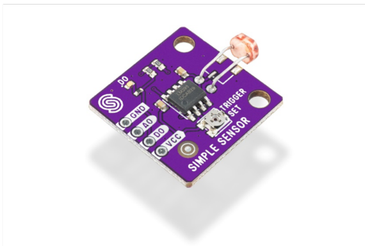
Slika 9. Jednostavni senzor svjetlosti
