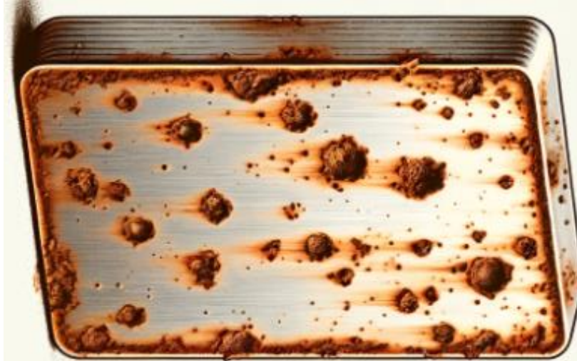
Slika 3. Komad metala s jednoličnom korozijom
