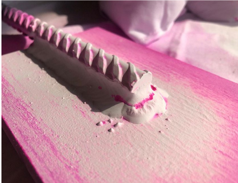
Slika 12 Penetrantska metoda kontrole Izvor: https://pondt.hr/penetrantska-kontrola/
