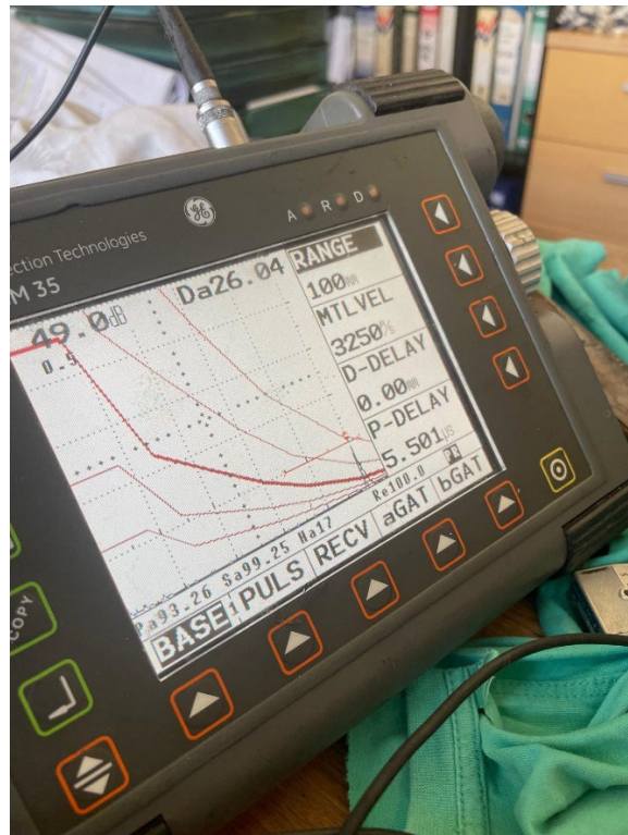
Slika 19 USM 35 uređaj pri kalibraciji
