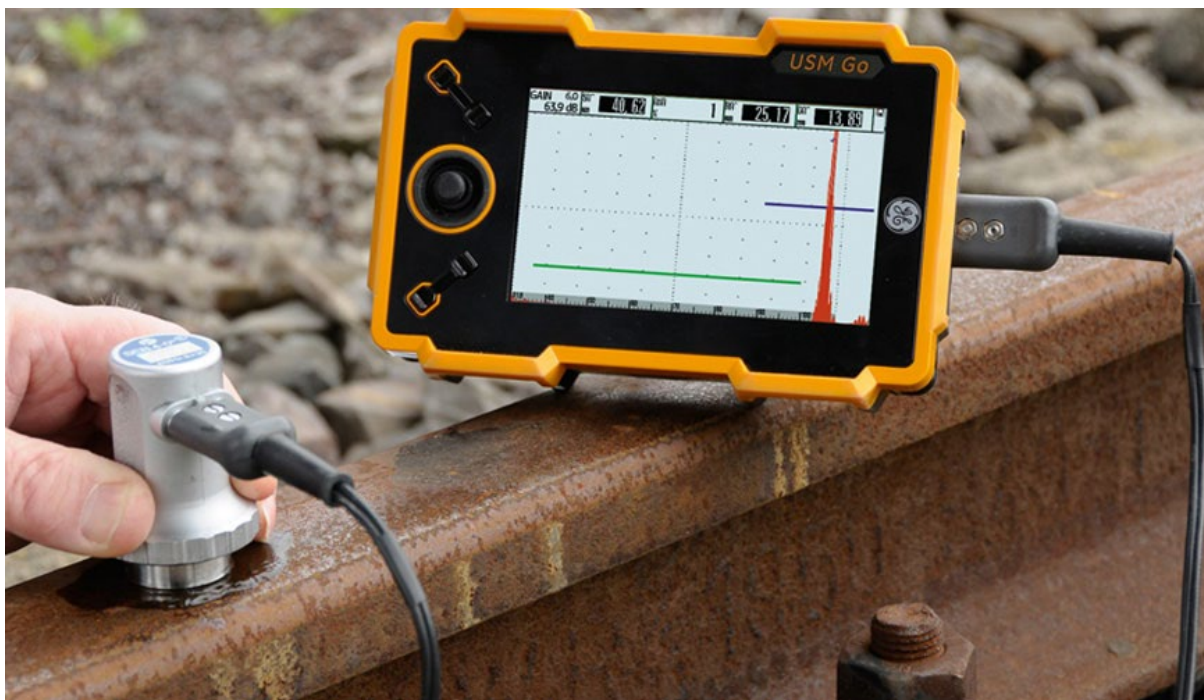
Slika 10 Primjer ultrazvučne metode ispitivanja
