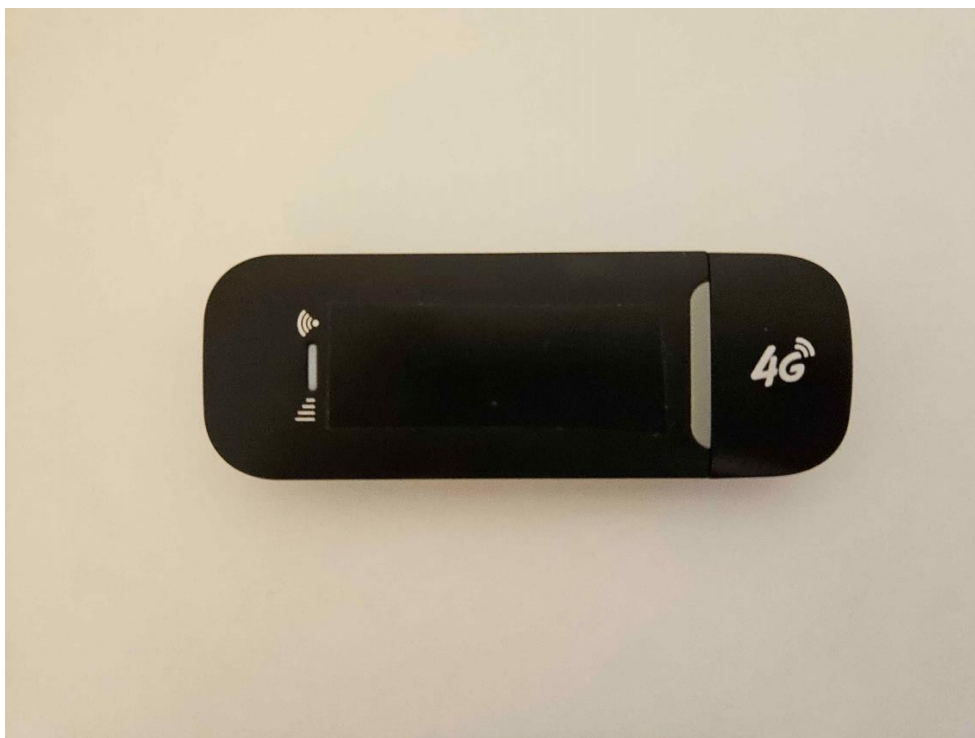
Slika 16: Qualcomm MDM9600 modem na USB adapteru.
