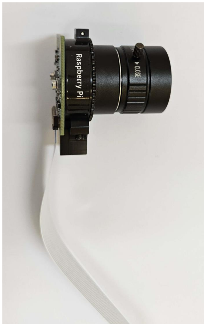
Slika 11: Raspberry Pi HQ kamera s objektivom.
