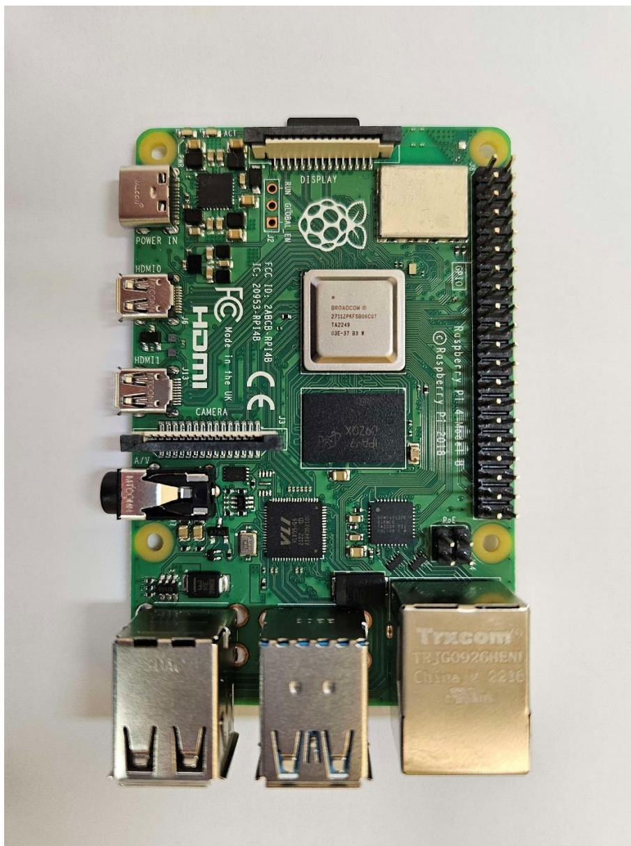
Slika 9: Raspberry Pi 4B mikroručunalo.
