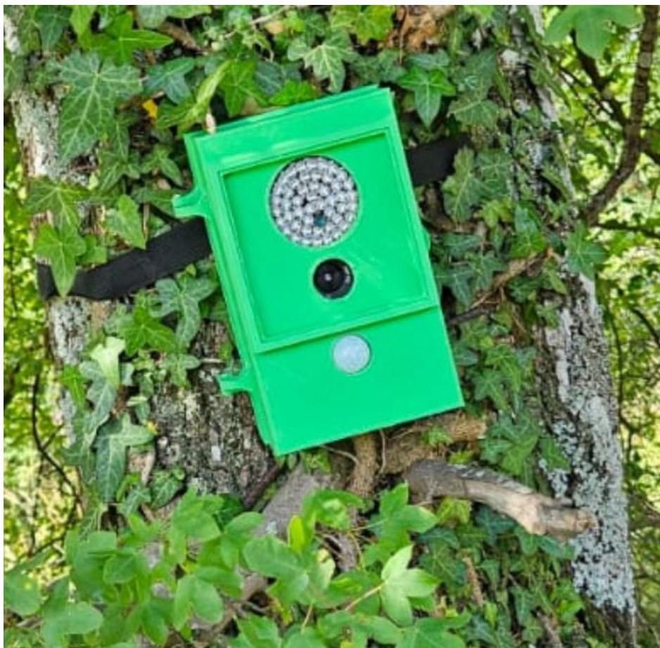
Slika 22: Kamera s automatskim okidanjem postavljena u divljinu.
