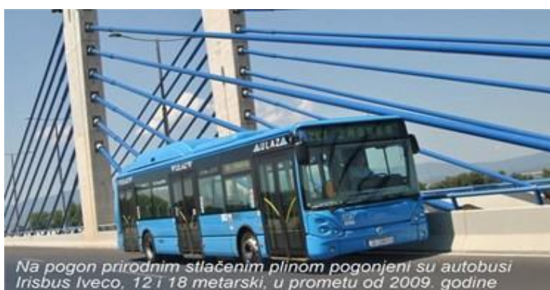
Nā pogon prirodnim stlačenim plinom pogonjeni su autobusi Irisbus Iveco, 12 i 18 metarski, u prometu od 2009. godine Slika 11. Autobus na pogon prirodnim stlačenim plinom.
