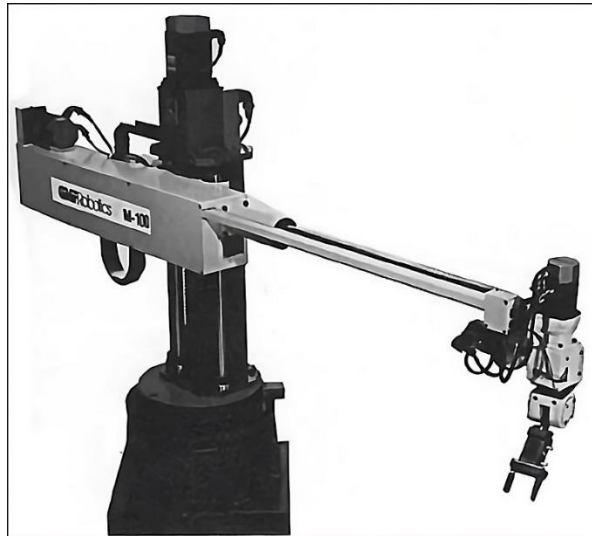
Slika 9: Prikaz robotskog manipulatora s cilindričnom konfiguracijom Izvor: https://www.onlinerobotics.com/sites/default/files/inline-images/Cylindrical_robot_0.jpg ,Preuzeto:05.09.2023.
