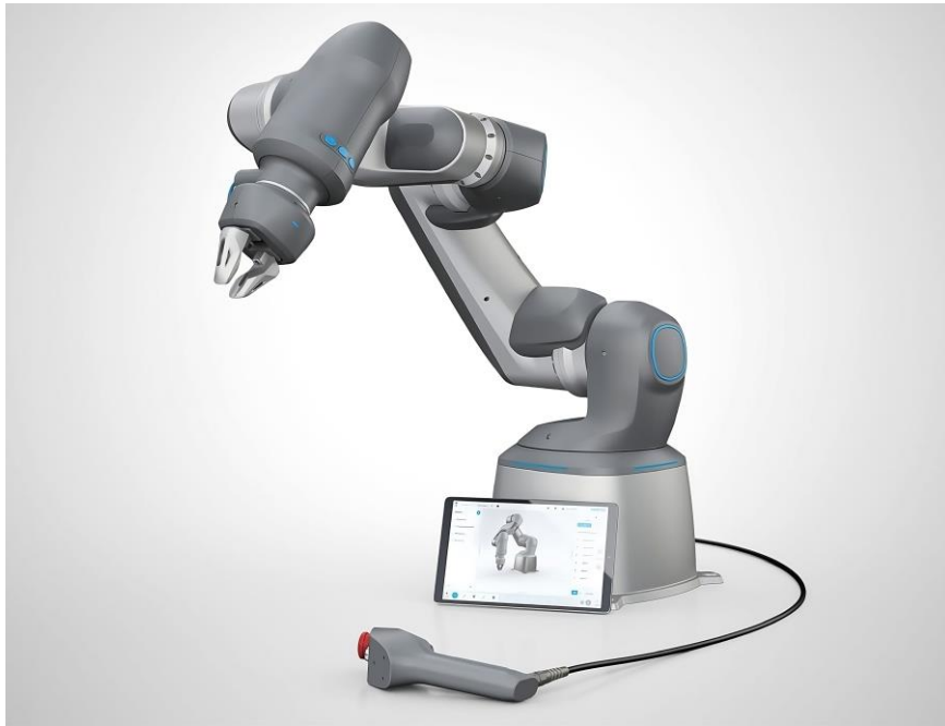
Slika 7: Prikaz robotskog manipulatora s pneumatskim aktuatorom Izvor: https://www.therobotreport.com/wp-content/uploads/2022/05/festo-cobot.jpg , Preuzeto:04.09.2023.
