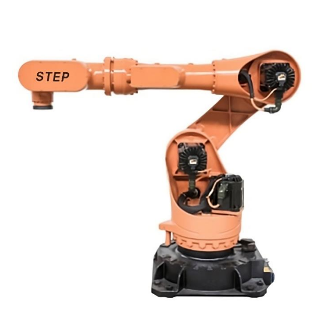
Slika 5: Prikaz robotskog manipulatora s elektromotorima
