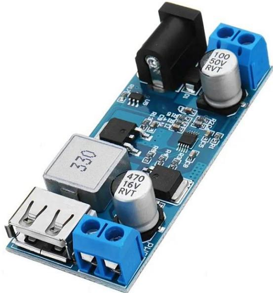
Slika 24: Prikaz DC-DC pretvarača XY 3606. Izvor:
