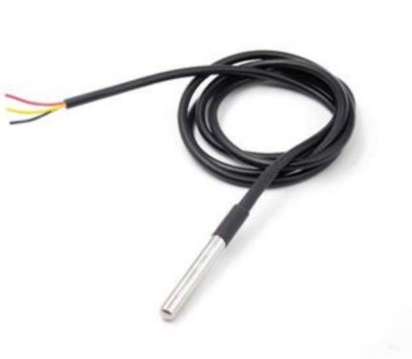
Slika 13: Prikaz DS18B20 senzora. Boje žica su: crna za uzemljenje (GND), crvena (VCC) za napajanje, žuta za podatke (DATA). Izvor: <https://lechacal.com/wiki/images/2/25/Waterproof-temperature-sensor-ds18b20-1.jpg>
