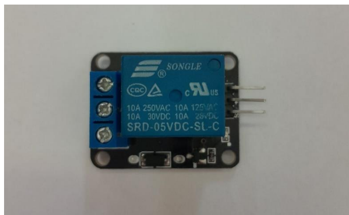
Slika 17: Fotografija relejskog modula kompatibilnog s Arduino UNO.
