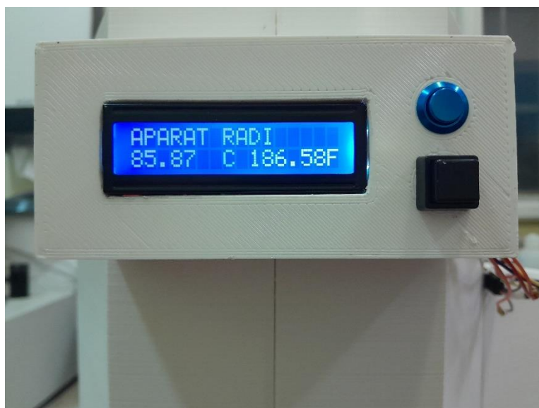
Slika 5: Fotografija kućišta za LCD zaslon s tipkalima.
