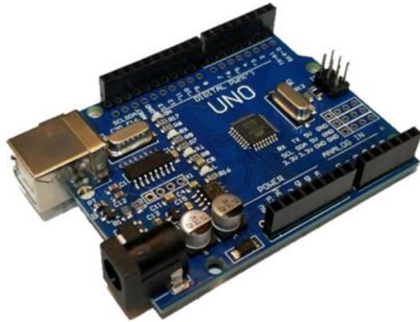
Slika 14: Prikaz Arduino UNO pločice. Izvor:
