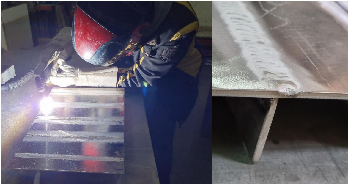
Slika 3. Prikaz ravnjanja odnosno unosa topline i prikaz zone utjecaja topline (ZUT)
