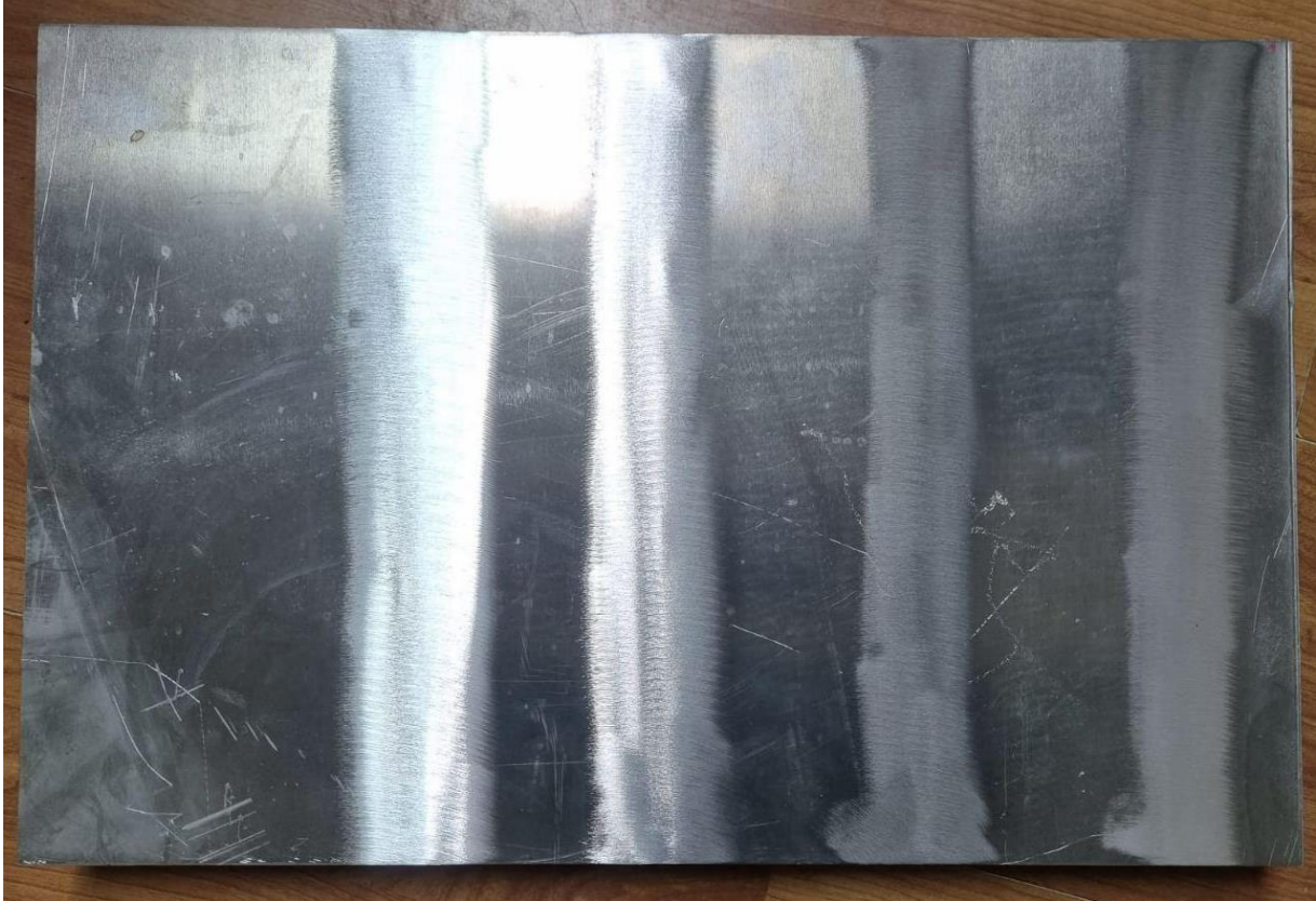
Slika 4. Odstranjen površinski sloj \text{Al}_2\text{O}_3
