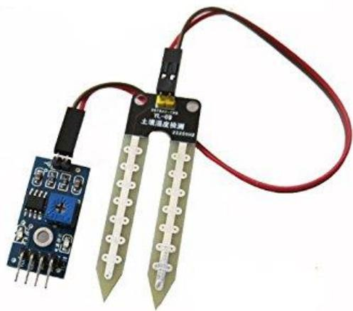
Slika 11: Prikaz Volumetrijskog senzora obloženog vitroplastom
