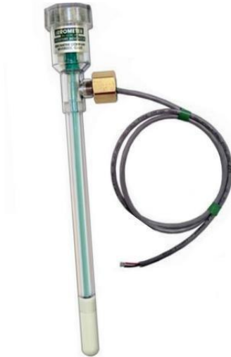
Slika 5: Prikaz softverskog irrometra
