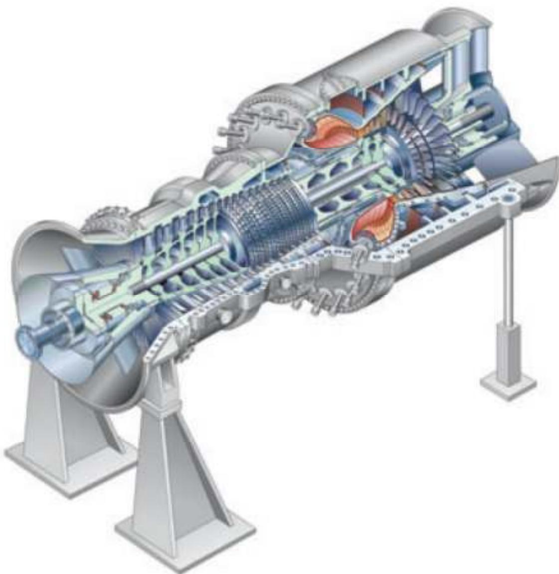
Slika 7: Primjer plinske turbine u presjeku
