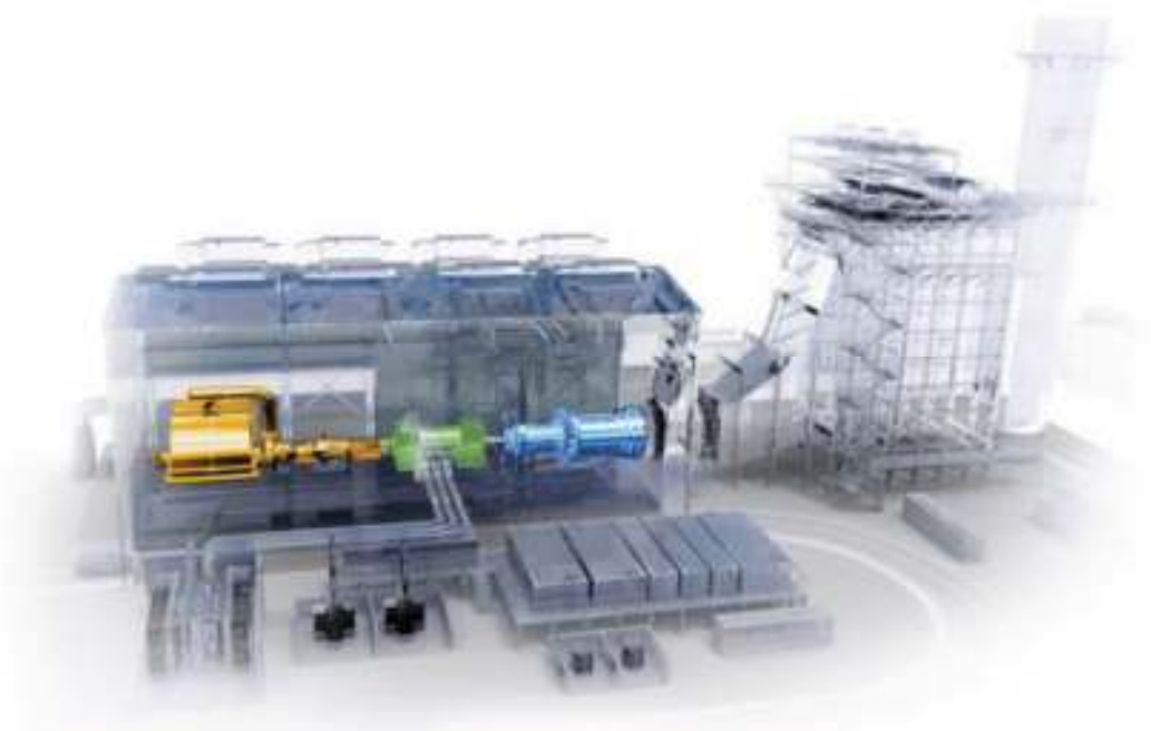
Slika 8: Primjer jednoosovinske izvedbe
