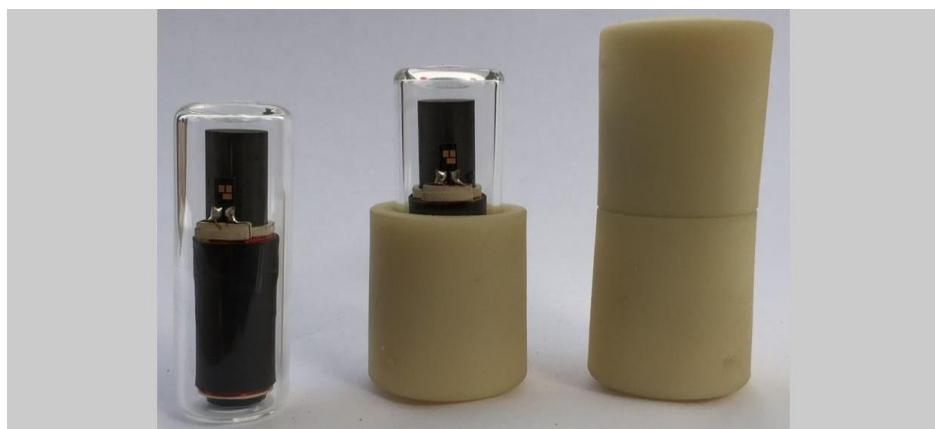
Slika 15: Primopredajnik za upotrebu sa AGV
