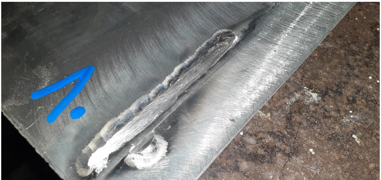
Slika 9. Ostaci zavarenog spoja
