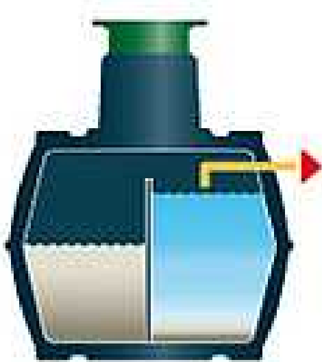
Slika 12: Postupak pročišćavanja postupkom SBR
