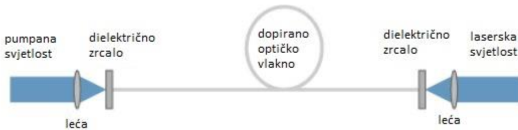
Slika 5: Shematski prikaz optičkog lasera
