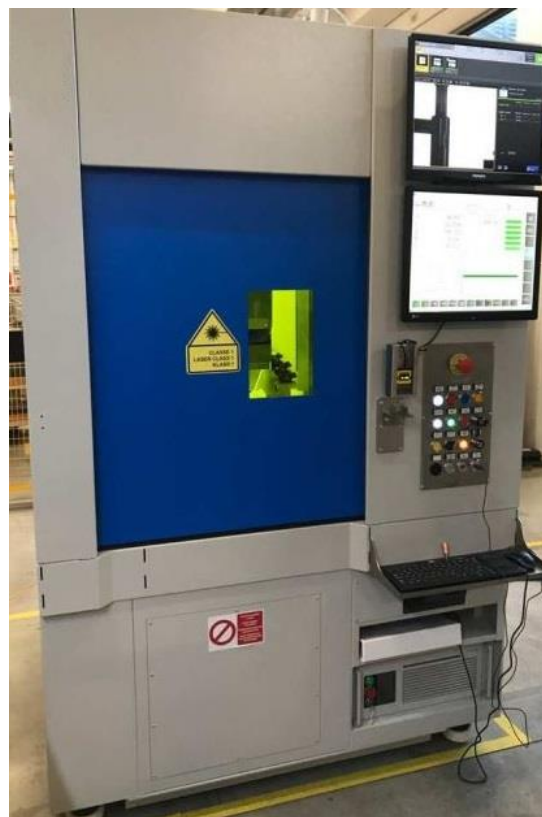
Slika 13: Stroj za zavarivanje s optičkim laserskim izvorom
